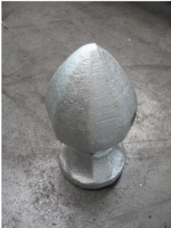
35. kép: Vastag acélöntvény tűzihorganyozva
