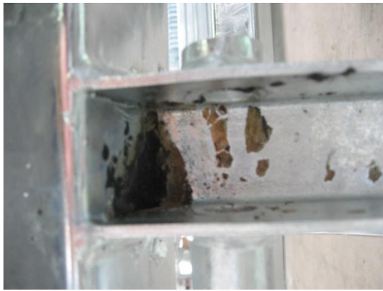
56. kép: Légzsák a hiányzó technológiai nyílás miatt
