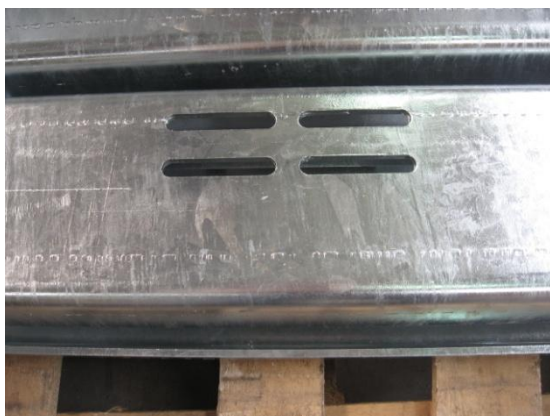
60. kép: A megmunkáló szerszámok nyomai horganyzás után is láthatók
