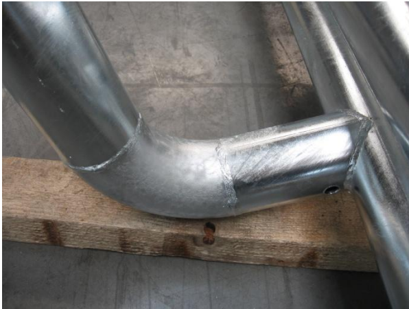
47. kép: Eltérő acélminőségek és alapanyag típus
