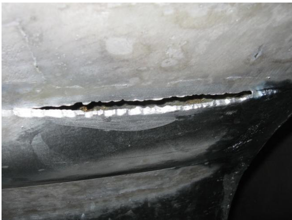
49. kép: Helytelenül kialakított átlapolás következménye
