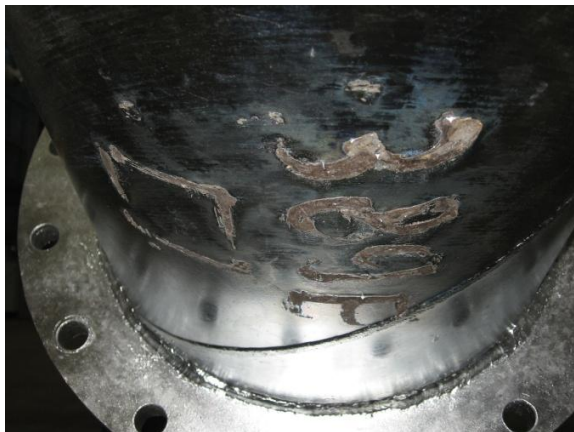
39. kép: Festékekkel történő jelölés okozta horganyhiányok
