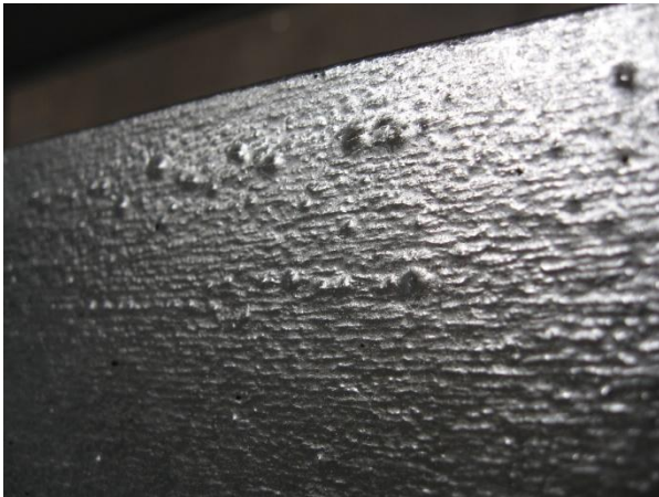
48. kép: Nem optimális acélminőség bevonata
