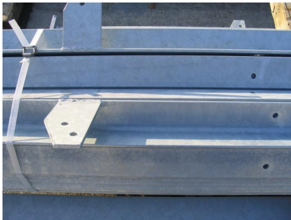
34. kép: Magas szilíciumtartalmú ( \text{Si} > 0,25\% ) acél horganybevonatai
