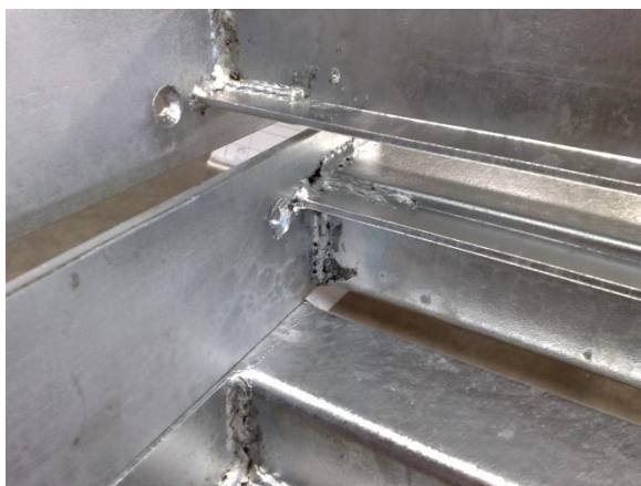
38. kép: Hibás hegesztés okozta horganyzó salak maradványok
