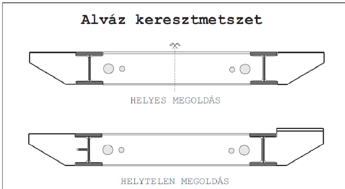
3. ábra: Helyes és helytelen alváz keresztmetszetek (példák)
