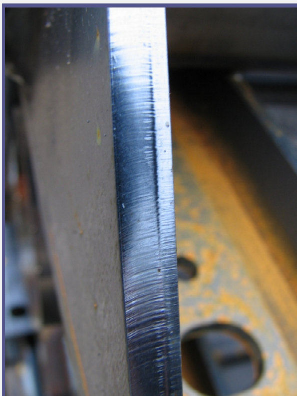
Túl vékony horganybevonat a lézerrel vágott felületen
