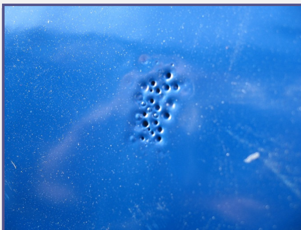
Egy hegesztési varrat felett "kigázosodott" a porszórt műanyagréteg
