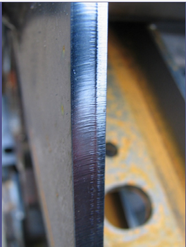
A plazma, vagy lézervágott felületek éles sarkai érzékenyek a bevonat leválására
