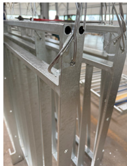
10. kép: Függesztés kötöződróttal
