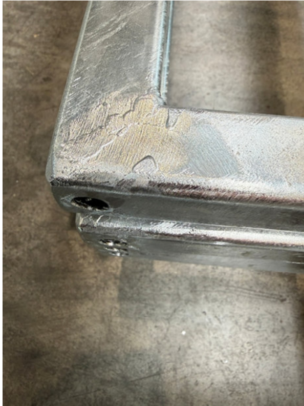
13. kép: Megfogási nyom utókezelése zártszelvény keretszerkezeten
