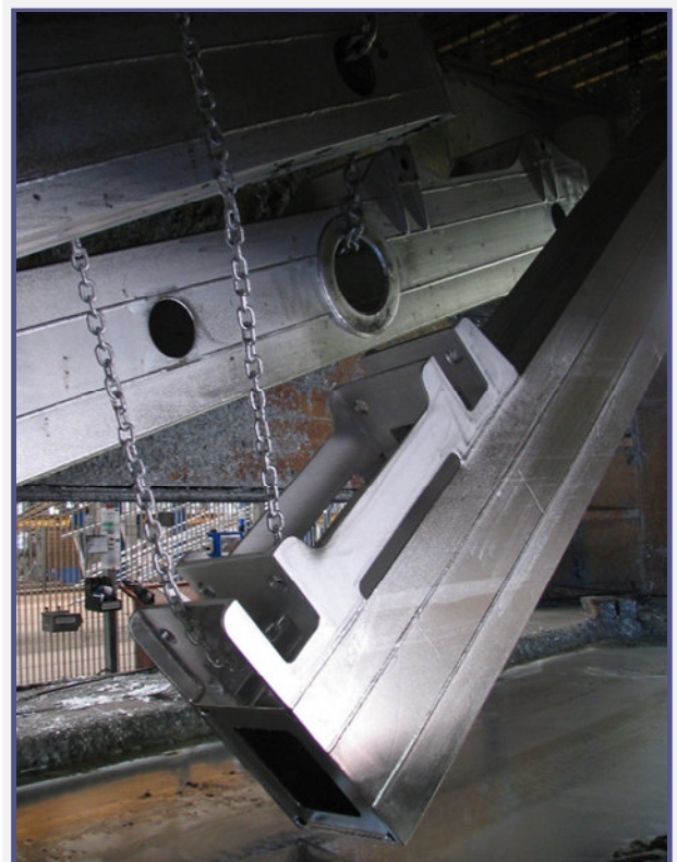
Felfüggesztés hőálló teherláncsal
