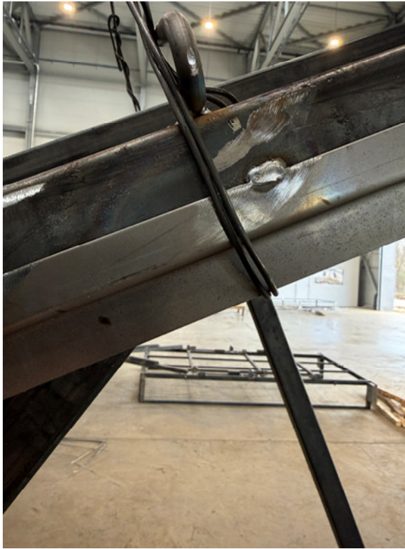
15. kép: A termék átkötése (a függesztésre alkalmas hely hiányában)
