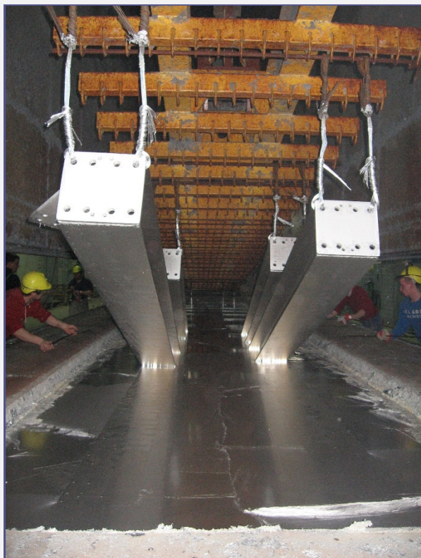
Gerendák felfüggesztése kötöződrót kötegekkel
