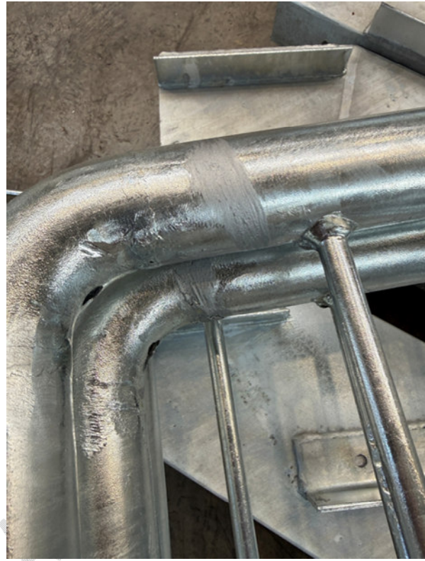
14. kép: Megfogási nyomok lemunkálása, javítása csőszerkezeteken
