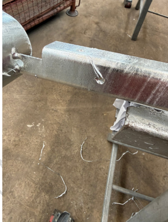
12. kép: Köözőhuzal nyoma, mint egy forrasztási nyom
