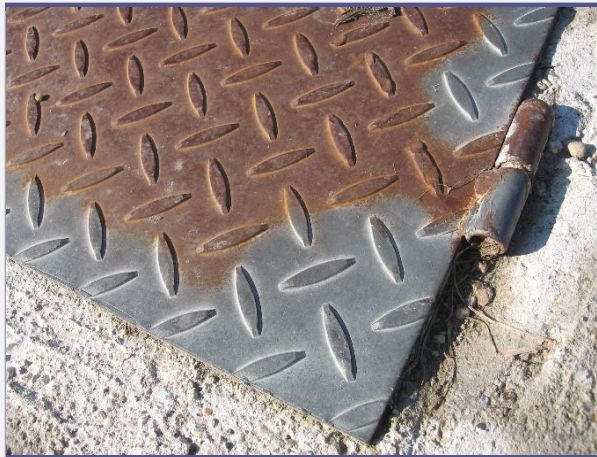
Túl vékony horganybevonat idő előtti korróziója
