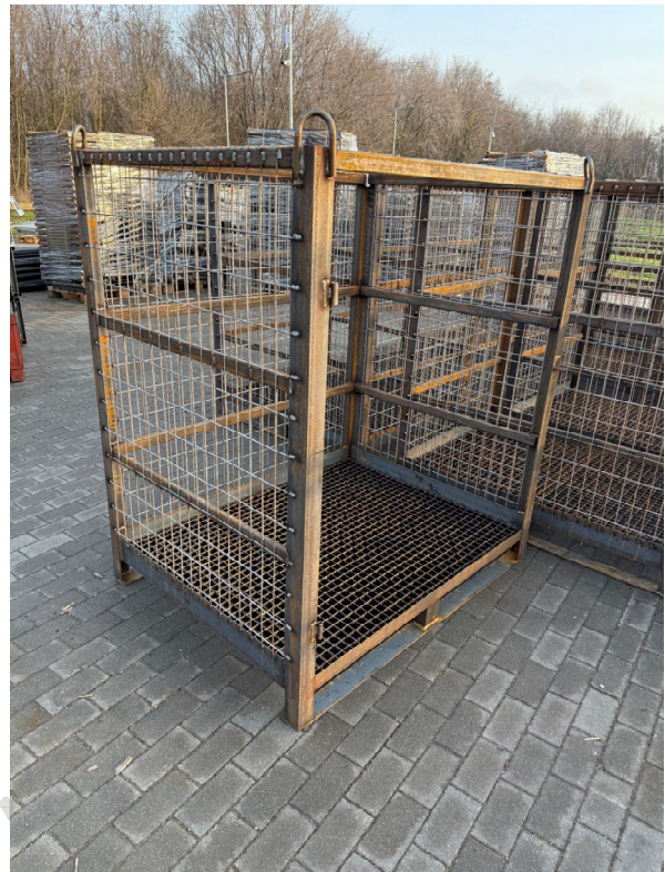
16. kép: Egyedi, nyitható konténer emelő fülekkel
