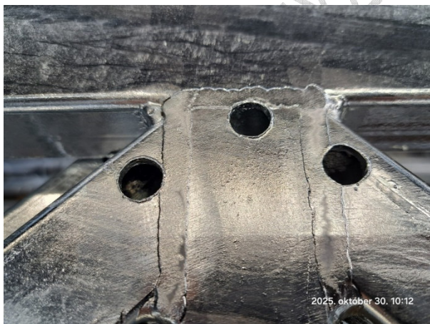
3-4. kép: Utólagosan elhelyezett technológiai nyílások problémákat okoznak
