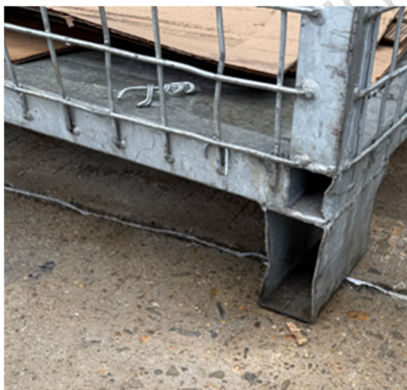
14. kép: Konténer alul nyitott lábbal
