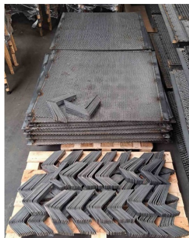
6-7. kép: Összeszerelhető kivitelben szerencsésebb a szerkezet tűzihorganyozása
