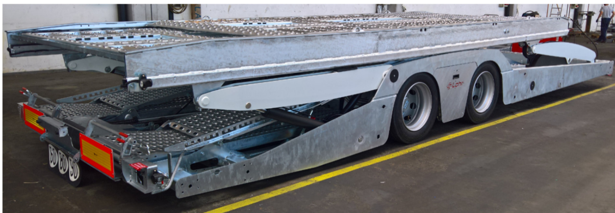
1. kép: A felépítmény teherviselő rakfelülete perforált, a furatoknál peremezett lemez
