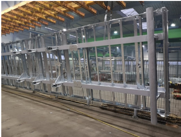
9. kép: Nagyméretű, háromtengelyes pótkocsi tűzihorganyzott alváza
