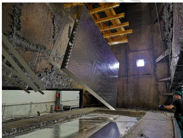
7. kép: Helyes kialakításnál és gyártásnál a síklemezek csak kismértékben vetemednek
