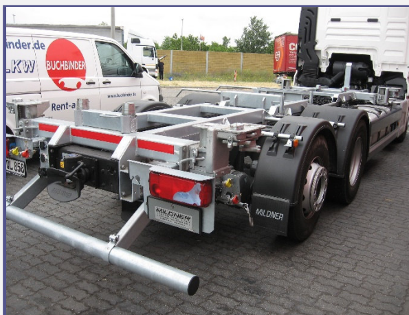
Tűzhorganyzott kivitelű kamion alváz
