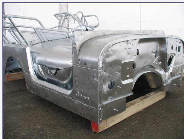
Tűzhorganyzott Jeep személygépkocsi váz
