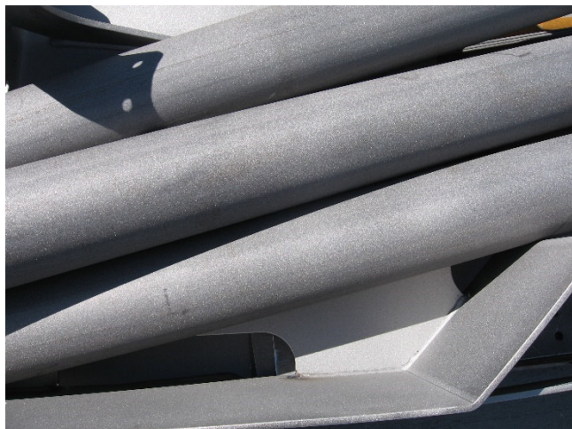
10. kép: Homokszórással megtisztított acélfelületek
