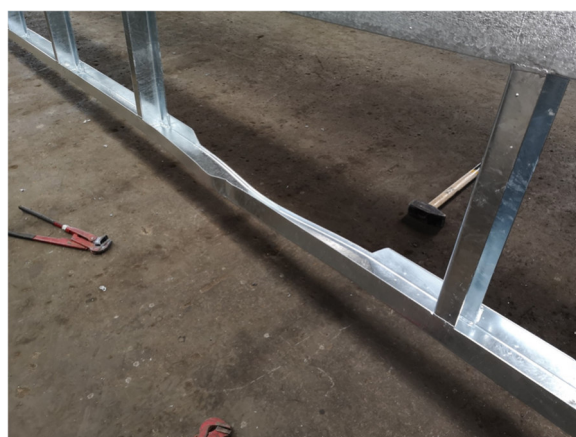
3. kép: Dilatációs feszültség miatti deformáció egy alvázban. A jelenségben az alapanyagvastagság miatti 4-szeres különbsége játszik szerepet
