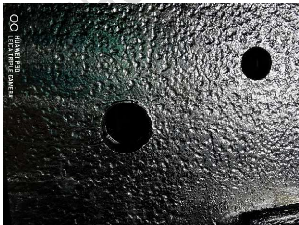
5. kép: Erősen bemaródott vasfelület bevonata
