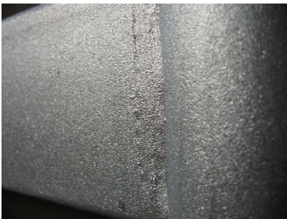
7. kép: Szemcseszórással revétlenített felület
