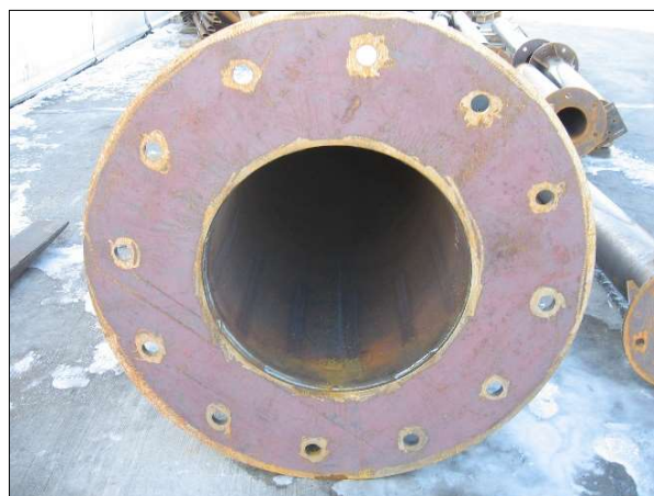
2. kép: Tömör, vastag revével borított felület
