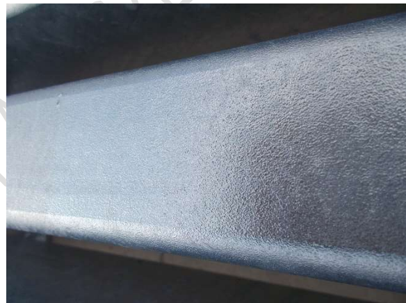
8. kép: Szemcseszórással tisztított termék bevonata
