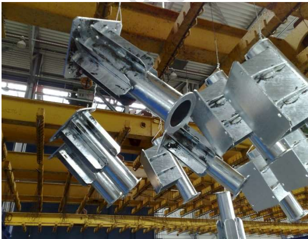
9-10. kép: Hegesztési feltapadásgátló spray nyomai a hőhatási övezetekben
