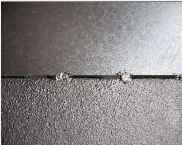
Alul egy vakrozsdás felület horganybevonata látható
