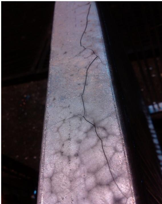
1. kép: Hosszú repedés a horganyrétegben
