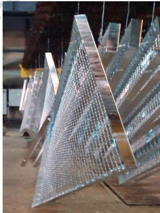
2. kép: Deformálódott keretszerkezet
