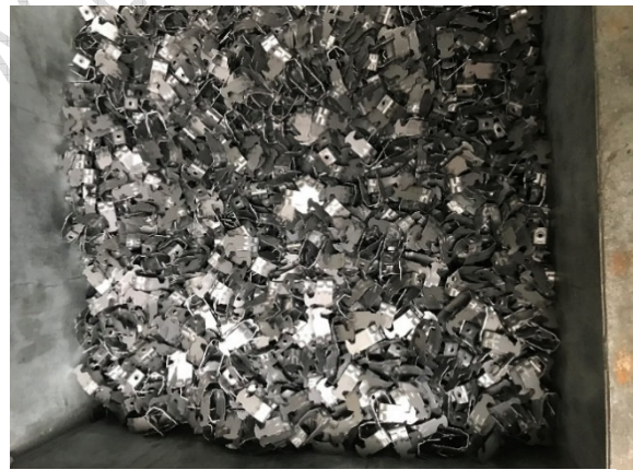
6. kép: Stancolt kábelrögzítő bilincsek tűzhorganyzás előtt
