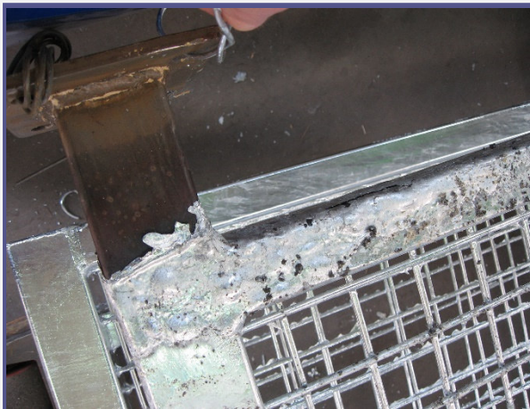
A technológiai furat hiánya miatt „megúszott” acélszerkezet hibás horganybevonata
