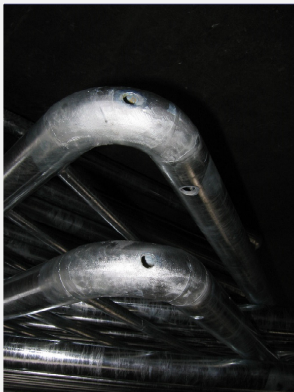
Az ilyen korlátok technológiai furatait horganyzás után célszerű műanyag dugóval ellátni
