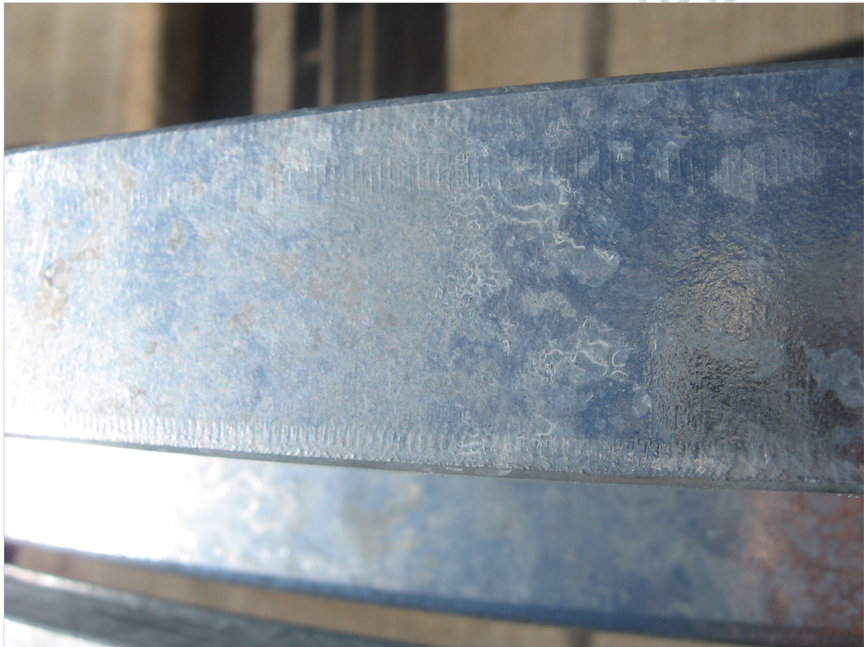
1. kép: Fehérrozsda egy frissen tűzihorganyzott felületen
