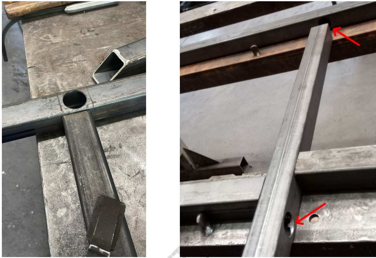
3-4. kép: Optimális kialakítású „rejtett” furatos acélszerkezet még összehegesztés előtt
