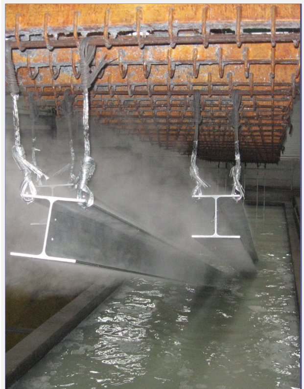
Melegen történő lakkozás folyamata tűzhorganyzást követően
