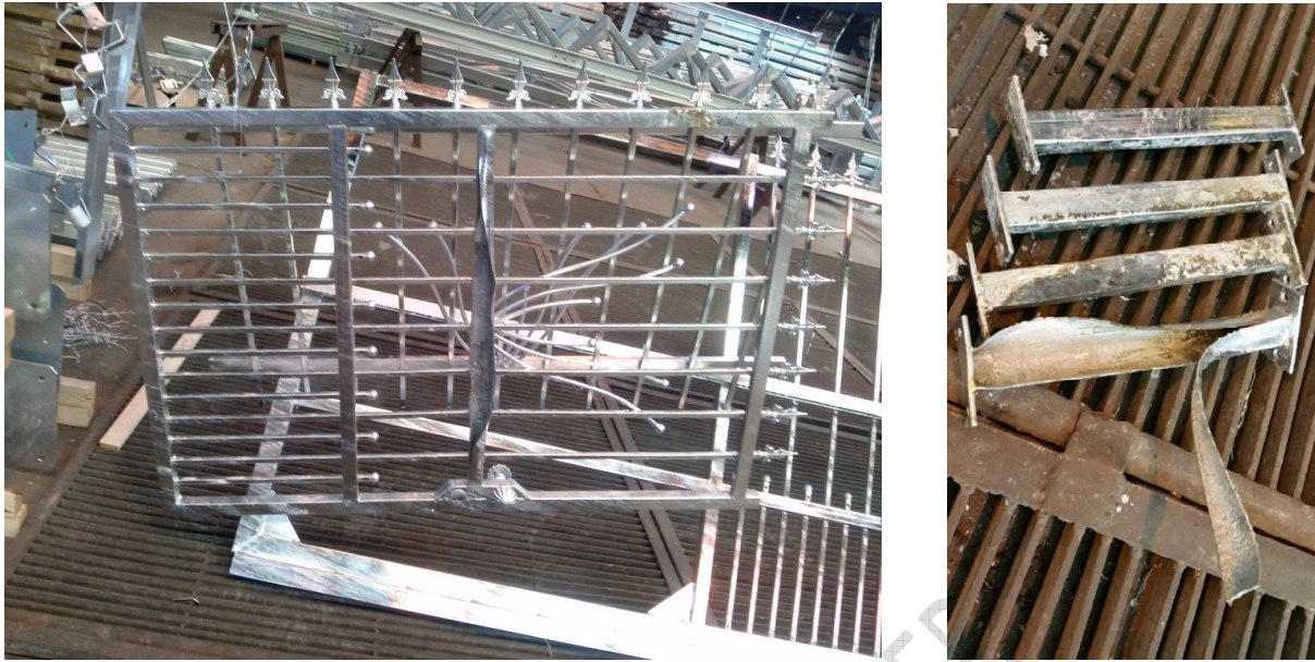
5-6. kép: Szétrobbanás miatt javíthatatlanul megsérült szerkezeti részek
