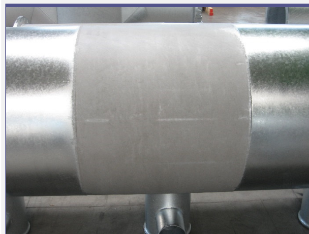
A csőszerkezeten a szürke bevonat 2-3-szor vastagabb, mint a fényes
