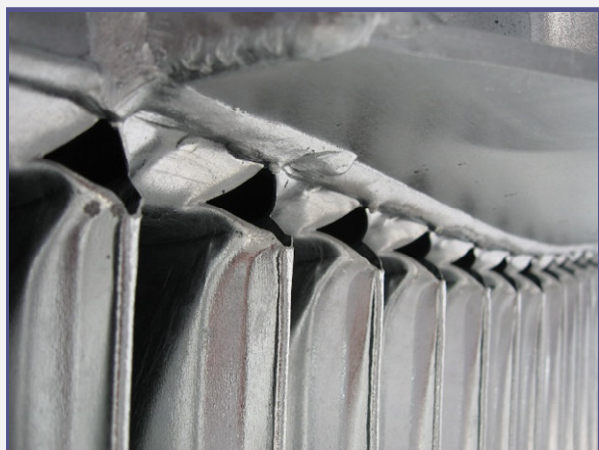
A rossz technológiai kialakítás miatt szétrobbant hőcserélő
