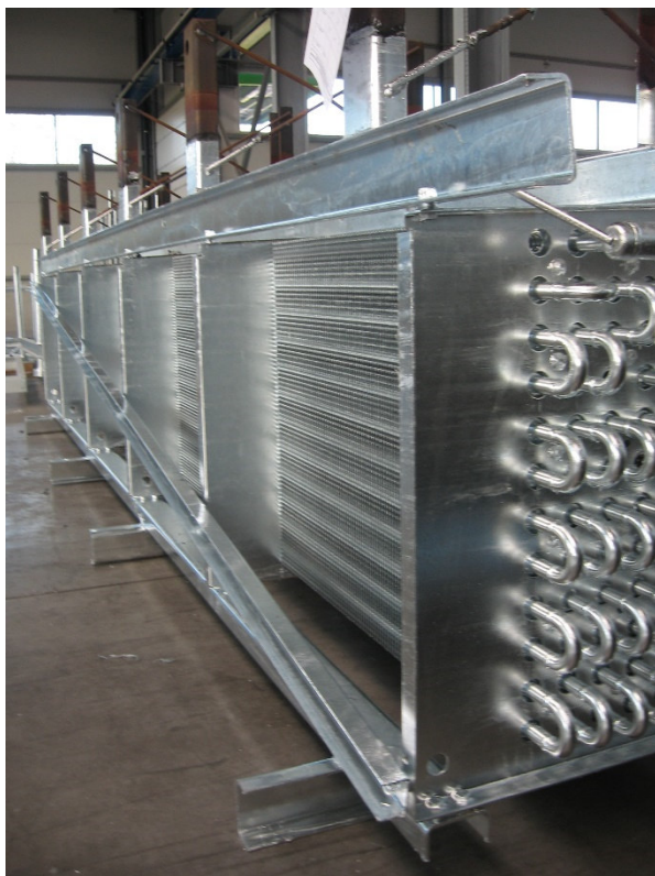
2-3. kép: Készre horganyzott hőcserélő blokkok
