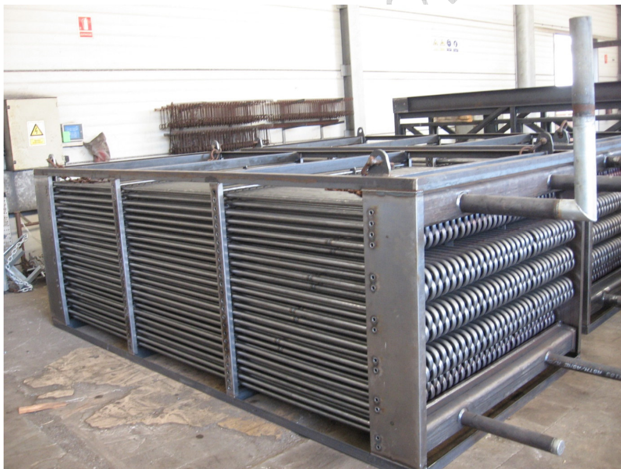
1. kép: Hőcserélő blokkok tűzihorganyzásra várnak
