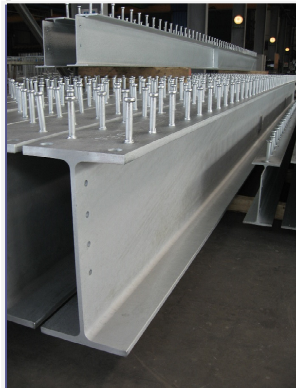
A hosszú acélszerkezetek bevonatainak vastagsága a hossz mentén jelentősen eltérhet
