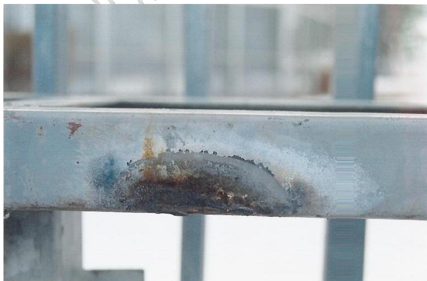
7. kép: Termikus egyengetés hatására elégett horganybevonat
