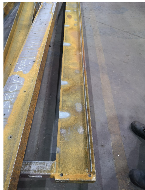
5. kép: „U” szelvényre hegesztett lapos acél okozta vetemedés egyengetése
