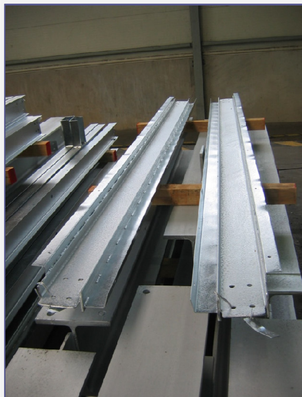
Sikeresen már nem egyengethető, meghullámosodott acélszerkezetek
