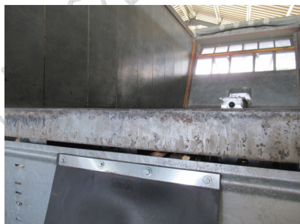
2. kép: Frissen horganyzott felület elszíneződése
