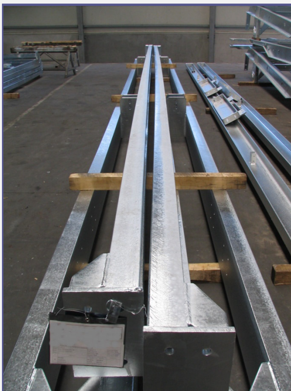
Helyes technológiával még hibátlanul egyengethető acélszerkezeti elemek
