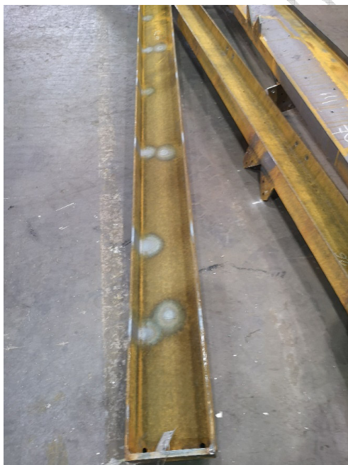
4. kép: Termikusan gyengetett szerkezet
