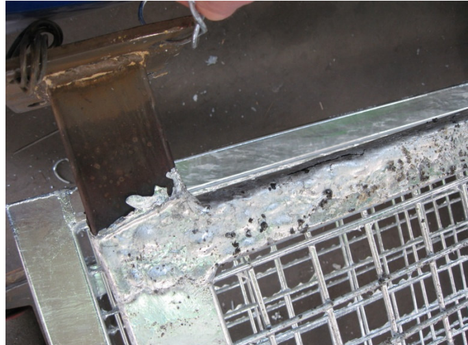
4-5. kép: Túl kisméretű technológiai nyílás (balra) és „megúszott, selejtes áru (jobbra)
