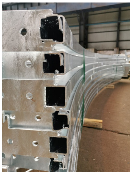
9-10. kép: Fényes, esztétikus horganybevonatok optimális méretű technológiai nyílásokkal
