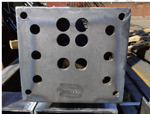
1-2. kép: A tűzhorganyzást segítő, nagyméretű technológiai nyílások
