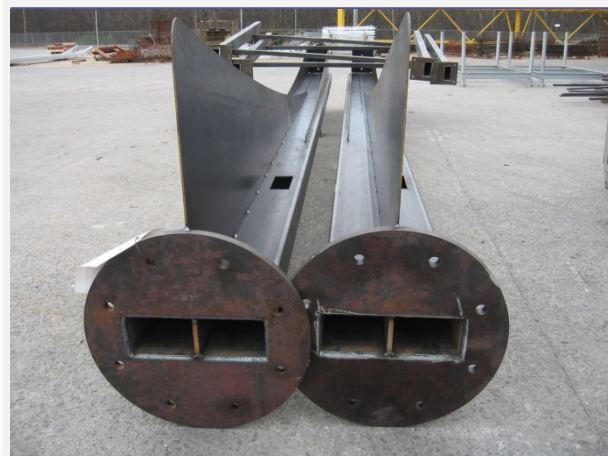
Nagyméretű zártszelvények, csövek esetén javasolt, kedvező technológiai nyílások
