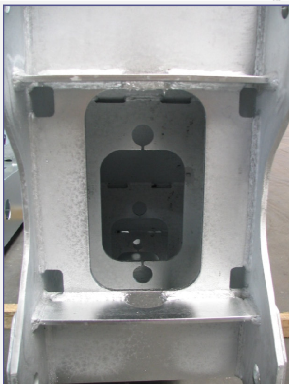
Szekerénytartó jellegű acélszerkezet helyes technológiai nyílásai
