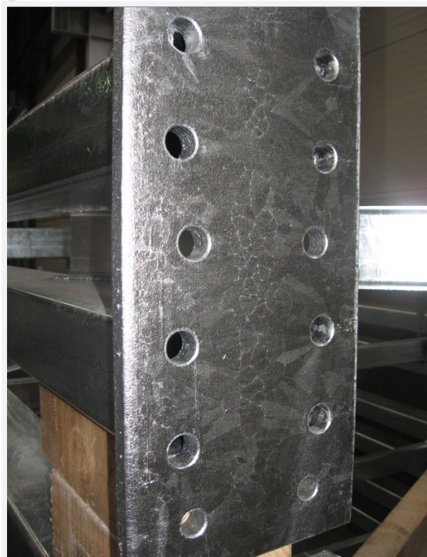
Zártszelvényes oszlop talplemez, vagy fejlemez helyes technológiai kialakítása
