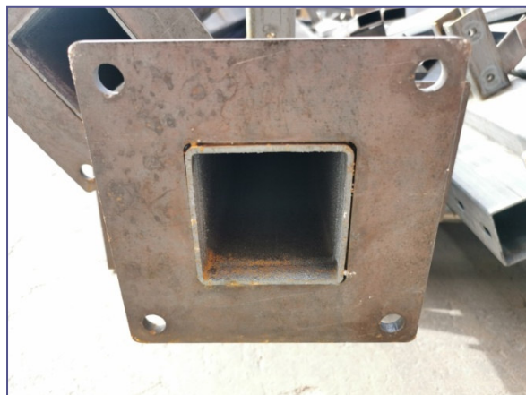
1-2. kép: A tűzhorganyzást segítő, nagyméretű technológiai nyílások
