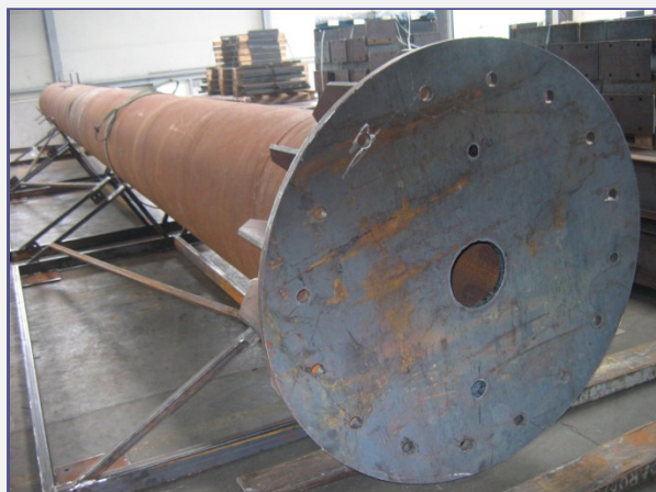
Minimálisan szükséges, de nem elégséges méretű technológiai nyílások
