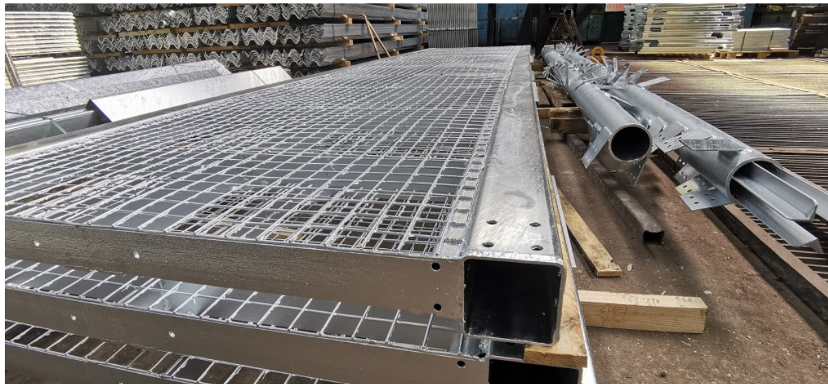
6. kép: A lehető legnagyobb technológiai nyílás kedvezően befolyásolja a termékminőséget
