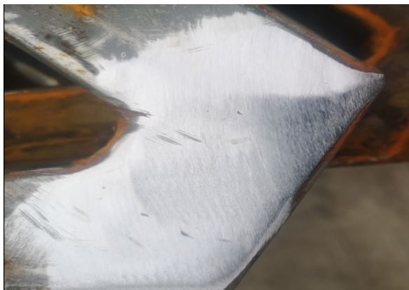
11-12. kép: Gondosan lemunkált acélfelület bevonás előtt (balra) és utána (jobbra)
