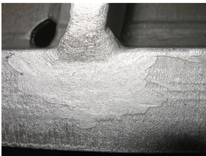
13-14. kép: Bevonatvastagság különbségek eltérő kémiai összetétel és felületi minőség miatt
