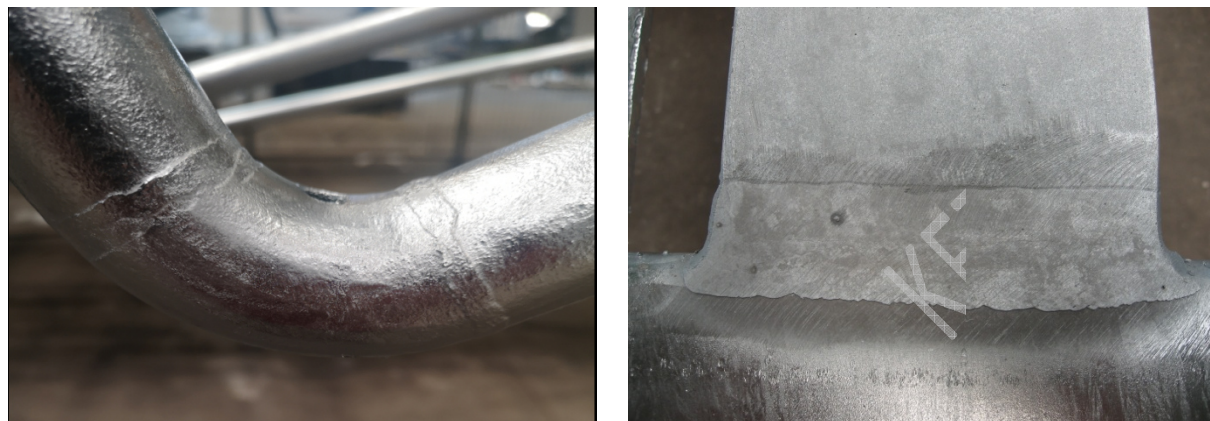
7-8. kép: A cső alapanyag és a hegesztési varrat kémiai összetétele közel áll egymáshoz (balra) és eltérő acélminőségek (jobbra)
