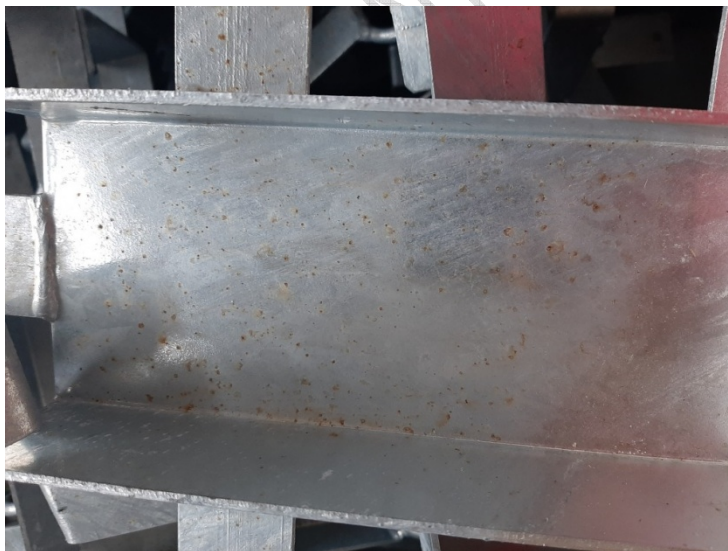
15-16. kép: Apróbb „idegen” rozsdá megjelenése a horganyzott termékeken
