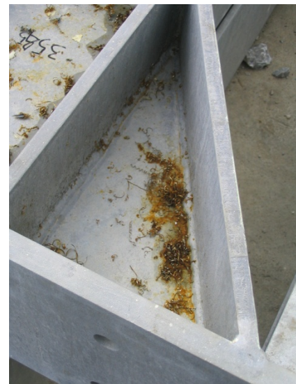
15-16. kép: Apróbb „idegen” rozsdá megjelenése a horganyzott termékeken
