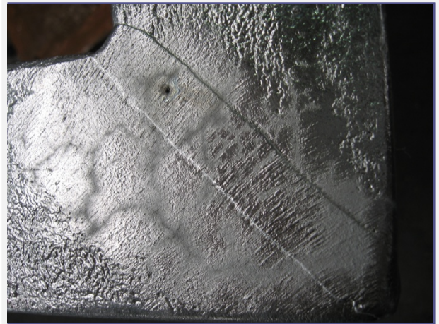
Tűzhorganyzáshoz nem optimális acélminőség, még kedvezőtlenebb hegesztési varratanyag összetétellel
