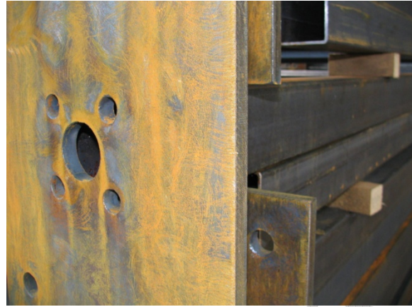
5-6. kép: Balra a túl kicsi, jobbra, a megfelelő technológiai nyílások
