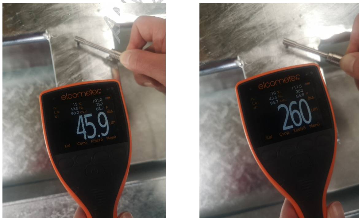
9-10. kép: Bevonatvastagság az alapanyagon (balra) és a hegesztési varraton
