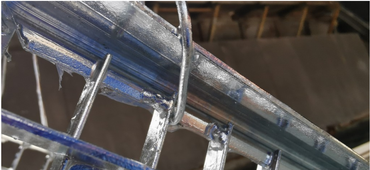
7. kép: Rácstermék dróttal történő kötése
