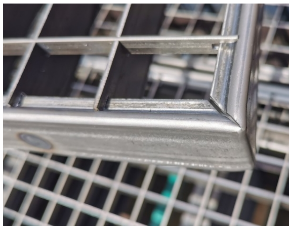
3-4.kép: Balra technológiai nyílások, jobbra a fő-és mellékbordák elhelyezkedése
