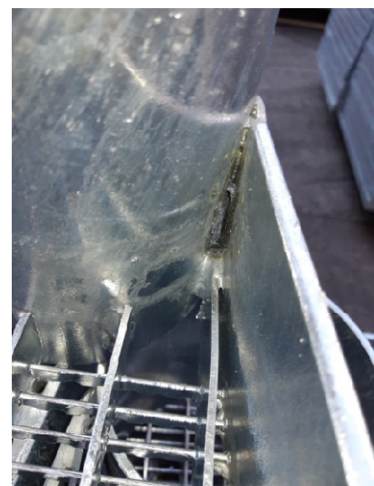
9. kép: Flux salak maradvány a sarokban
