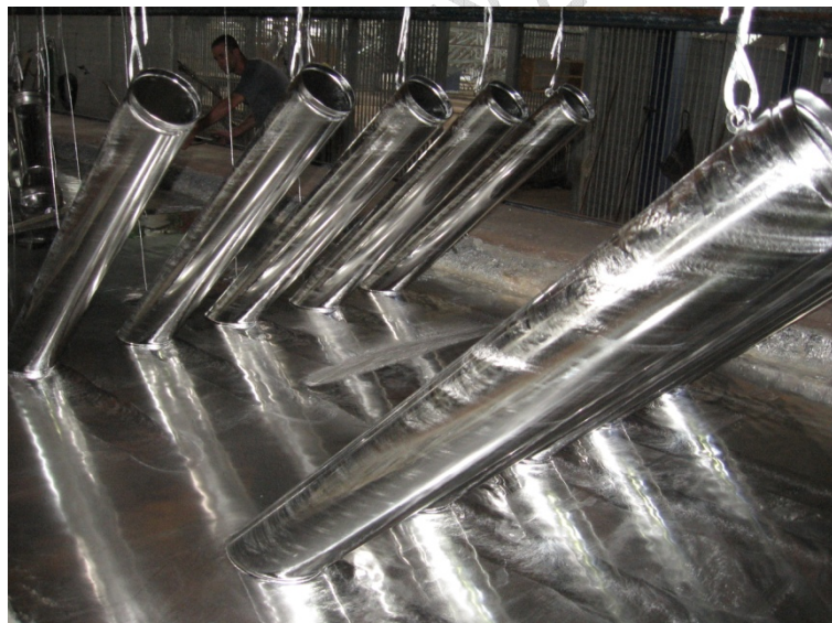
10. kép: Hosszabb csövek tűzihorganyzás közben
