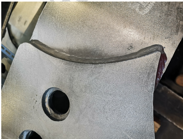
16. kép: Átlapolásnál a horganyréteg változó vastagsággal (fényes és szürke)
