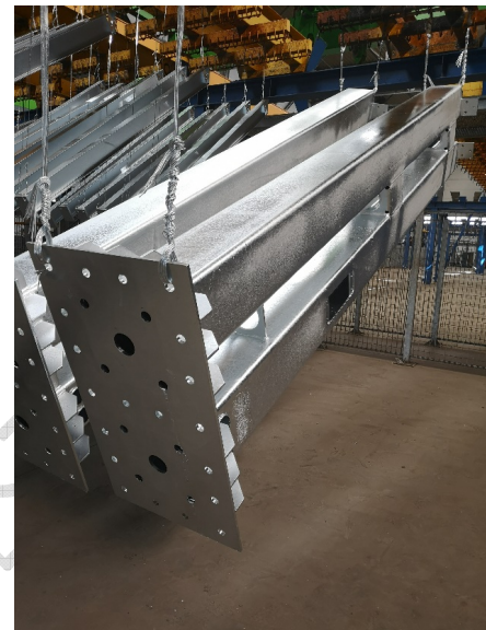
15. kép: A zárt szelvény oldalán is jól láthatók a hőfoltok
