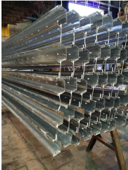
6. kép: Tűzhorganyzott trapéz-szelvények kampózva
