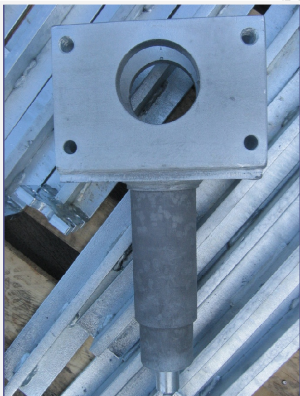
Tömör köracél felületén kialakult sötétszürke réteg (hő okozta bevonati jelenség)
