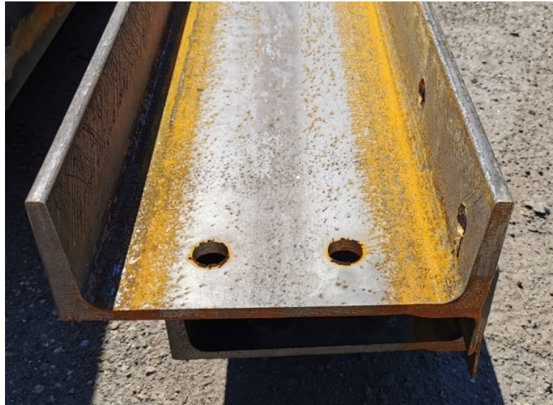
7. kép: U-szelvény kötési pontjai
