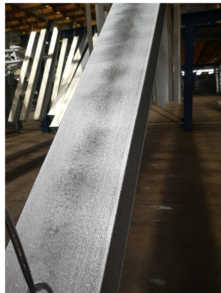
13. kép: HEA-szelvény, lehűlés sebességétől függő, látványos hőfoltokkal
