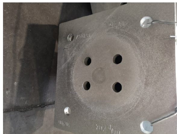
17. kép: A zárt, belső tér (cső) miatt a lemezközépen kialakult hőfolt
