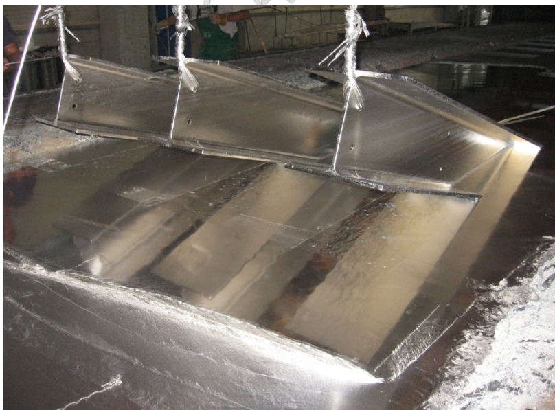
8. kép: I-szelvények tűzhorganyzás közben
