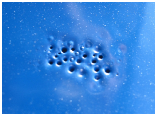
5. kép: Kigázosodás nyomai a porfestett bevonatban
