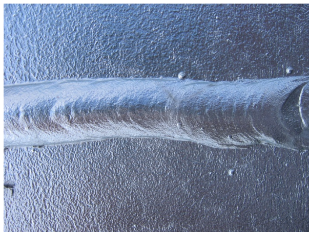
3. kép: Kiváló minőségű tűzihorgany bevonat
