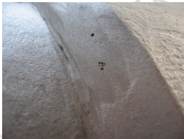
4. kép: Gázzárványos hegesztési varrat
