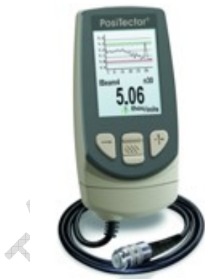
7. kép: Rétegvastagság mérő készülék
