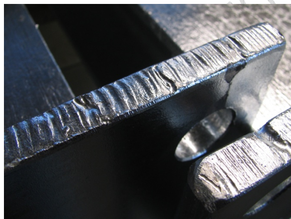
1. kép: Termikusan vágott élen vékony a bevonat
