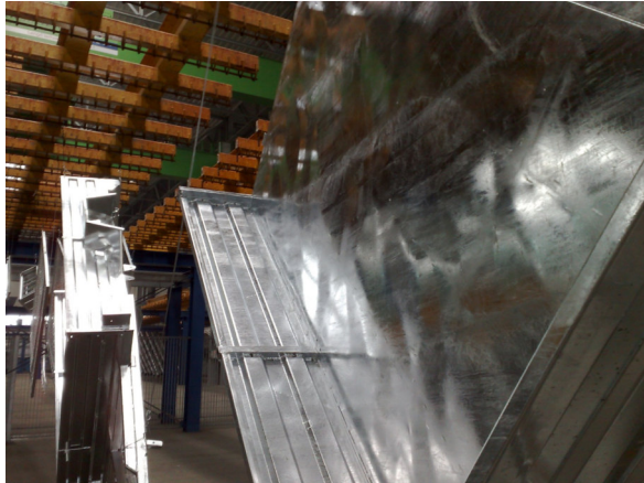
18. kép: Bordázott oldalfala, hullámosodott rakfelület lemez
