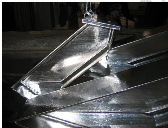
20. kép: Kiemelés a kb. 450 °C-os horganyolvadékból
