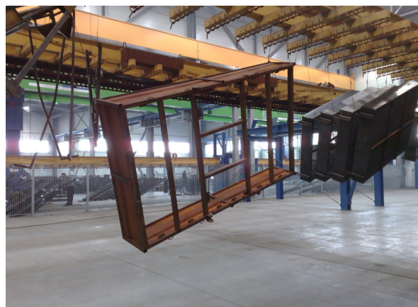
17. kép: Szakszerűen felfüggesztett utánfutó alváz
