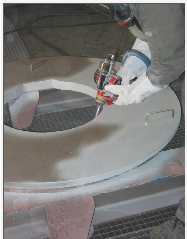
Horganyréteg felszórása kézi fémzóró berendezéssel
