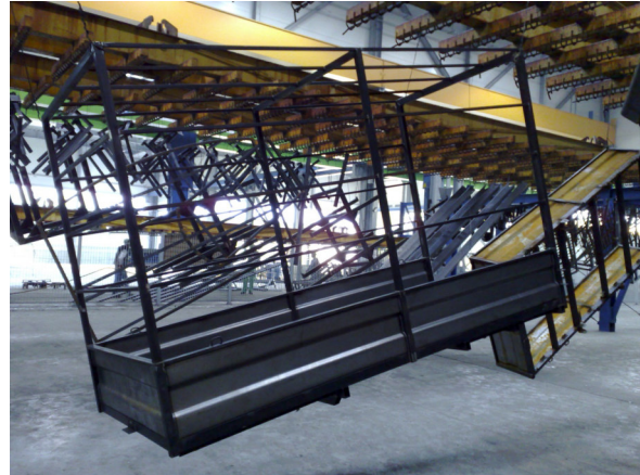
19. kép: Szabálytalan kialakítás, nem megfelelő horganyzási helyzet
