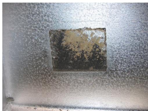
18-19. kép: Bevonathiányok a nem megfelelő jelölés miatt
