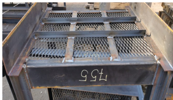
16-17. kép: Nem „technológiaálló”, nem ajánlott jelölési módok
