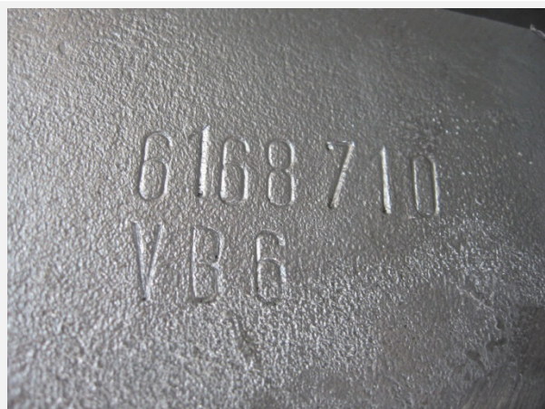
Fontos a megfelelő mélységű beütés, hogy a bevonat alatt is jól látható legyen
