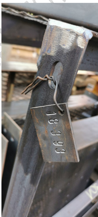
8-9. kép: Felfüggesztett tikettes azonosítás
