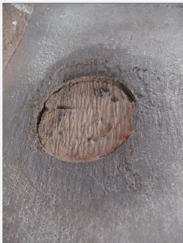
A szorosan beütött keményfa dugó is megfelelő menetvédelmet biztosít
