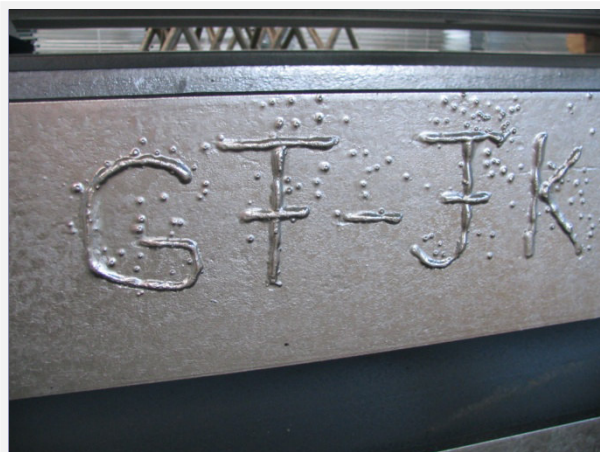
Egy nem esztétikus, de mindenképpen „hatékony” jelölési módszer
