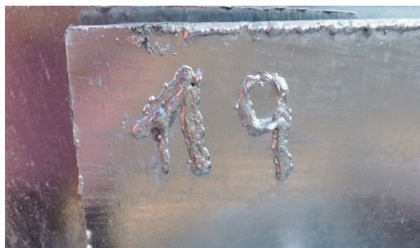
14-15. kép: Beköszörült és felhegesztett azonosító jelölések
