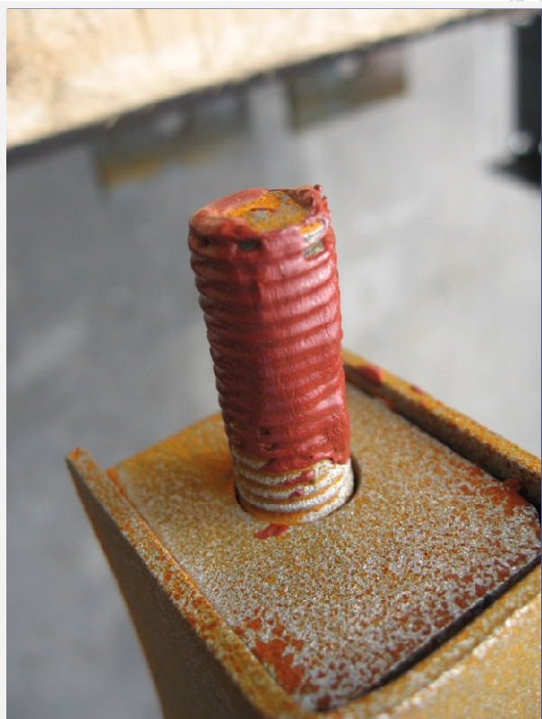
Menetes szár védelmére felkent műanyag bevonat nem minden esetben elegendő menetvédelem
