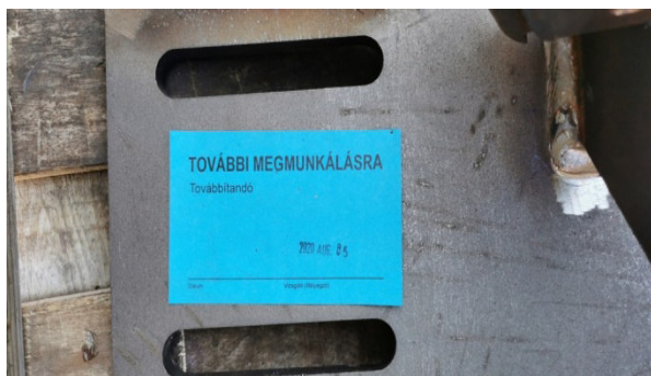
16-17. kép: Nem „technológiaálló”, nem ajánlott jelölési módok
