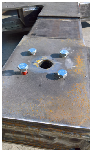
4. kép: Zsákfuratok betekert csavarokkal
