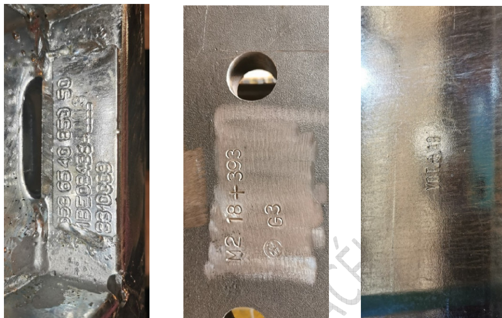
10-12. kép: Felhegesztett tikettes, kézzel, valamint géppel beütött azonosító jelölések
