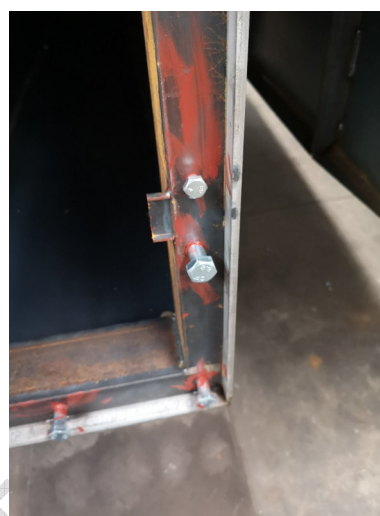
6. kép: A terméken szétkent menetvédő anyag
