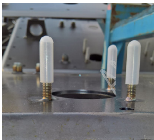
1-3. kép: Szilikon hüvelyek és menetvédő anyák
