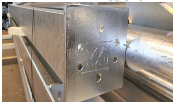
14-15. kép: Beköszörült és felhegesztett azonosító jelölések
