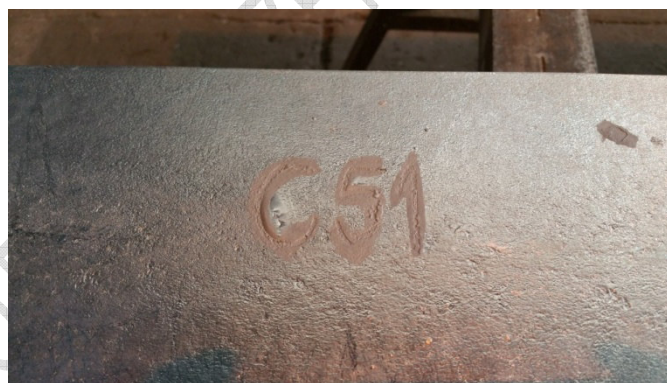
18-19. kép: Bevonathiányok a nem megfelelő jelölés miatt
