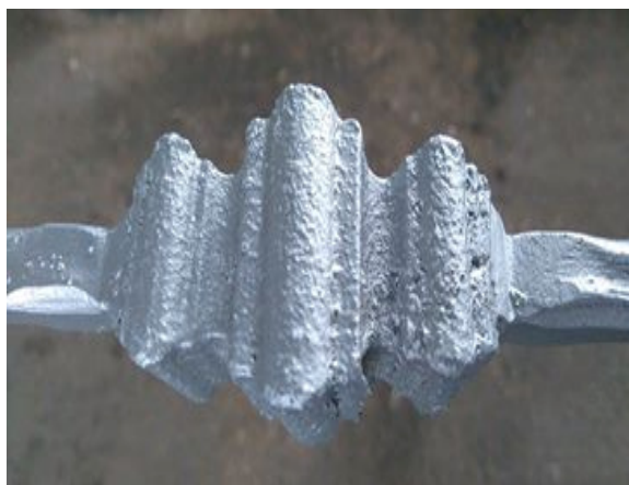
16. kép: Durva felület, vastag, pórusos réteg
