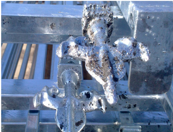
17. kép: Felületen maradt öntészeti maradványok okozta hiba
