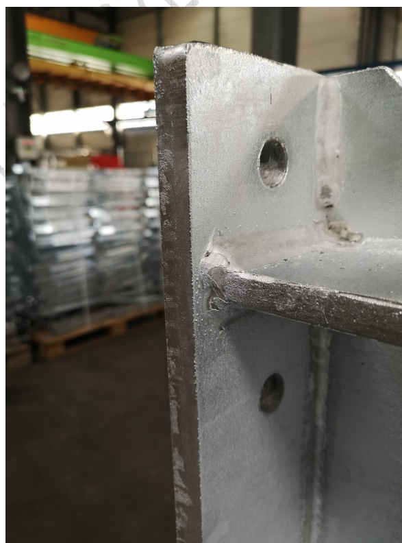
2. kép: Megmunkálás nélküli, termikusan vágott felület tűzihorganyzás után
