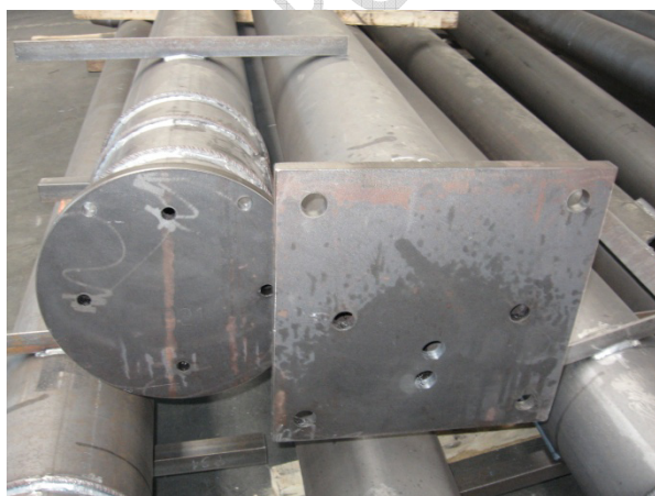
7. kép: Túl kicsik a technológiai nyílások a nagytármérőű csöveken
