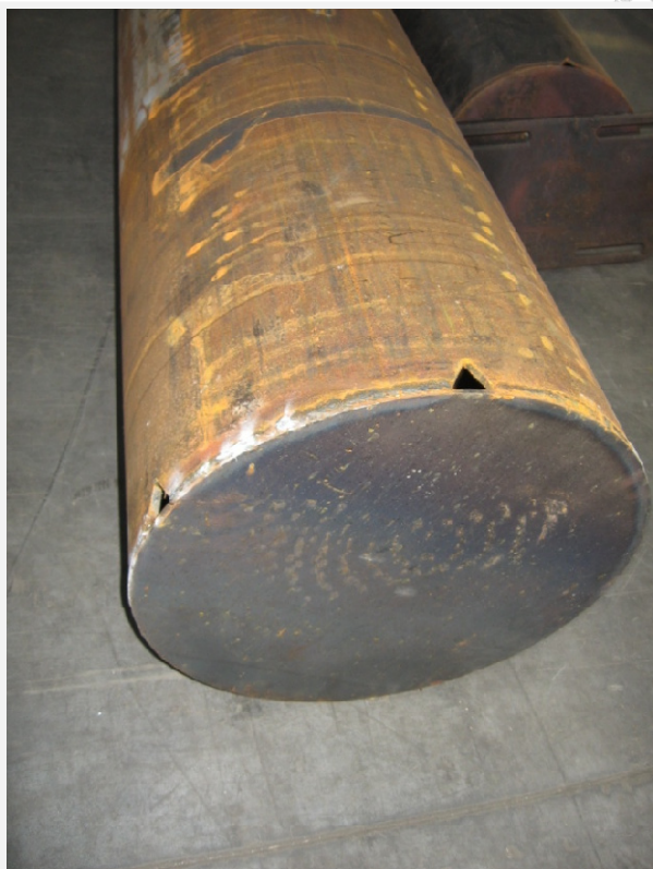
Túl kicsi technológiai nyílások a nagytérű csövön
