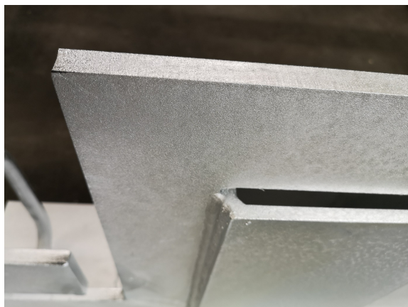
3. kép: Gyártás után szemcseszórt terméken, a vágási éleken is azonos minőségű a bevonat, mint az alapanyagon
