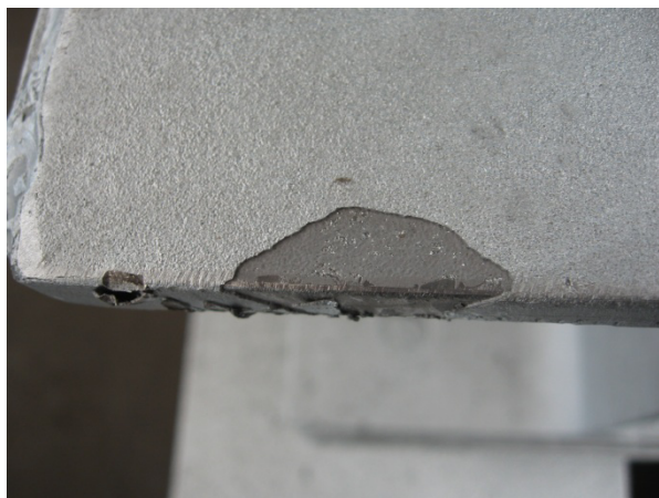
9. kép: Ütésre szétvált a bevonat
