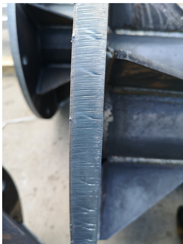
1. kép: Jellegzetes lángvágott felület acélszerkezetekkel
