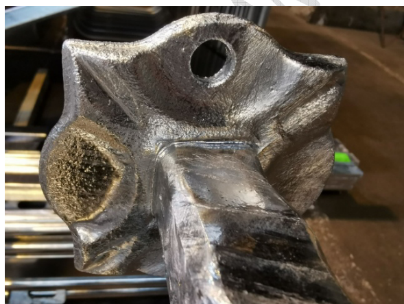
15. kép: Fényes felület, optimális bevonat
