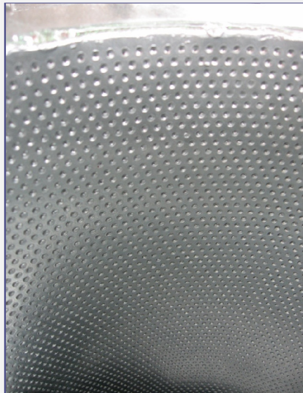
A horgany befagyott a perforált lyukakba, ami a használhatóságot erősen korlátozza.
