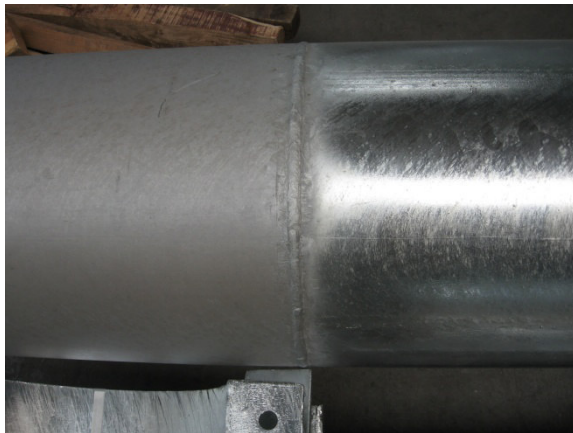
1-2. kép: Tűzhorganyzás szempontjából jelentősen eltérő acélok összehegesztve
