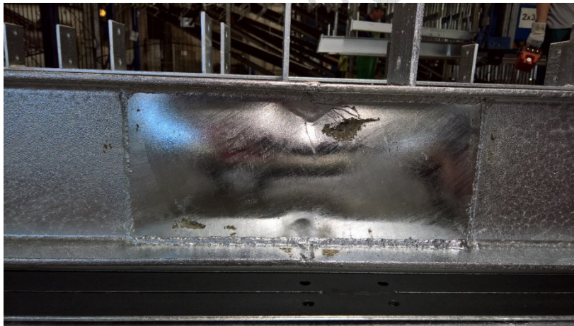
12. kép: Hiányzó technológiai nyílás, a kialakult túlnyomás hatására a lemez felpúposodott
