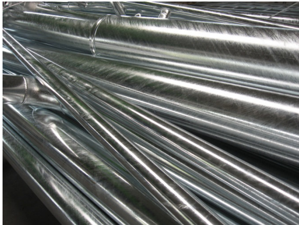
5-6. kép: Tűzihorganyzáshoz kedvező acélminőségből gyártott termékek felületei (friss és több éves)
