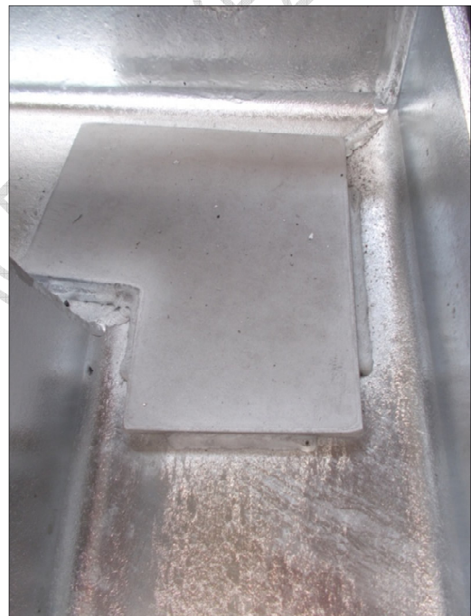
9. kép: Hegesztési varrat megszakítása
