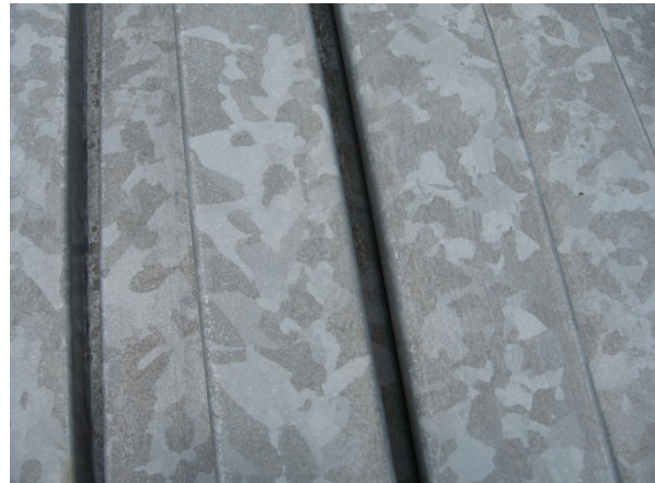
5-6. kép: Tűzihorganyzáshoz kedvező acélminőségből gyártott termékek felületei (friss és több éves)
