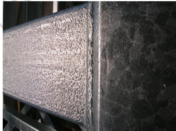
1-2. kép: Tűzhorganyzás szempontjából jelentősen eltérő acélok összehegesztve
