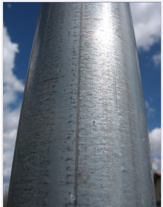
Vékonybevonatos, horganyzott szalagból hengerek között hajlított cső tipikus megjelenési képe.
