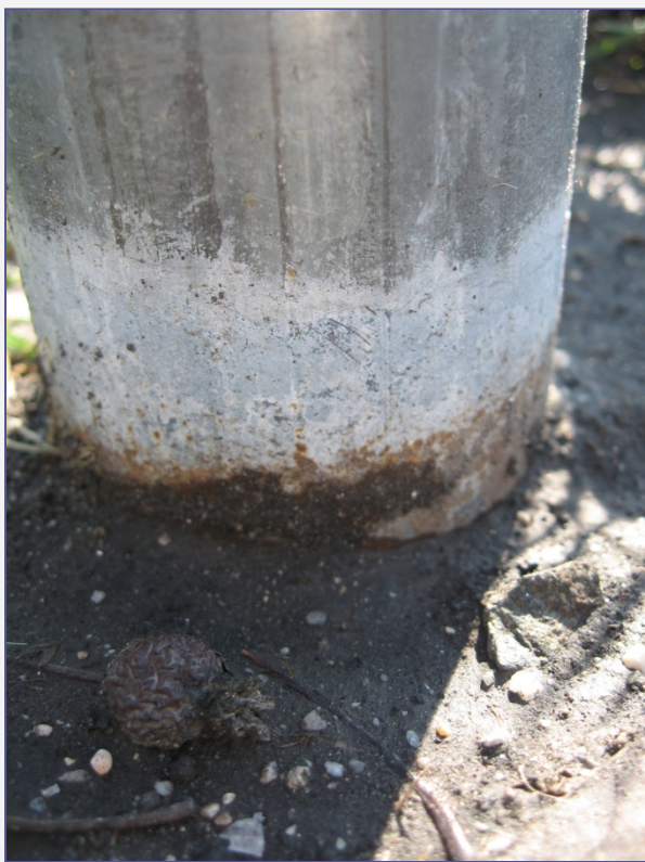
A túl vékony horganybevonat először a talaj közelében kezd elfogyni.
