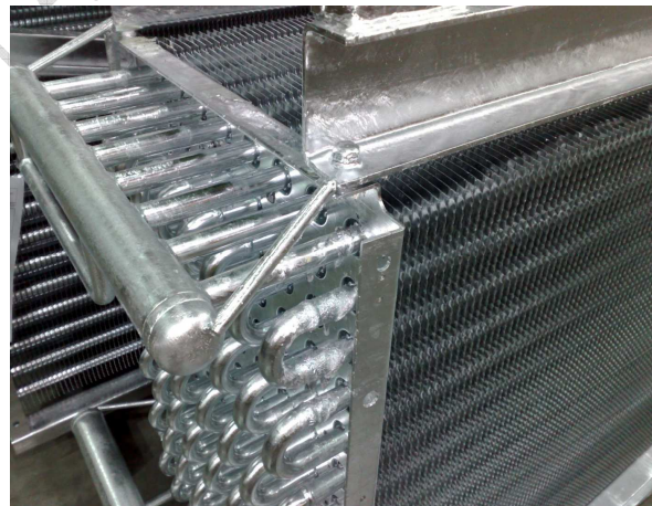
5. ábra: Hibás tartókeret kialakítás. Kiemeléskor a folyékony fém a hőcserélőre folyik
