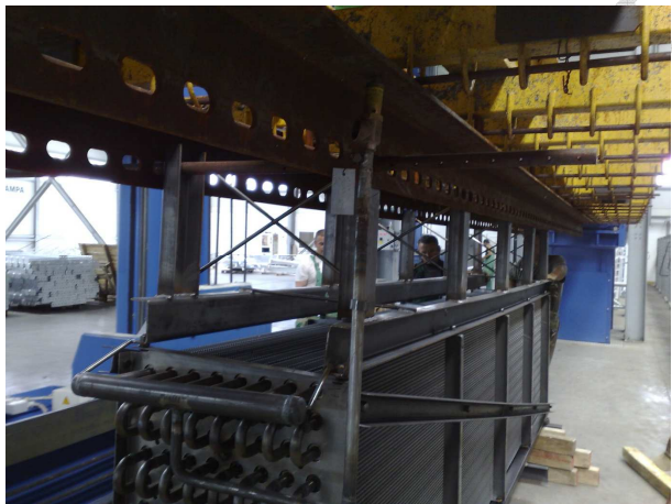
4. ábra: Hőcserélő kialakítása és csatlakozása horganyzó készülékhez
