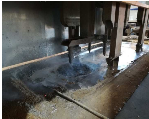
11. ábra: A horganyolvadék a termékek bemerítése után
