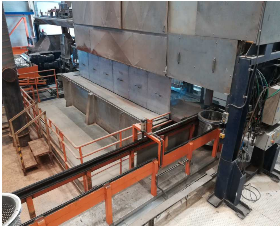
10. ábra: Centrifugás horganyzás egy berendezése
