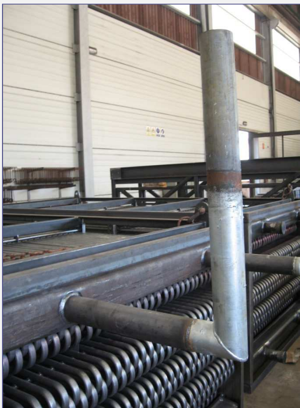
A hőcserélőkre biztonsági, nyomáskiegyenlítő csomkokat, vagy szelepeket kell elhelyezni.
