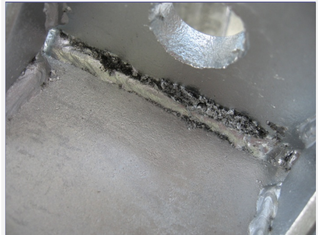
A szakszerűtlenül elvégzett hegesztés hiányos horganybevonatokat eredményez.
