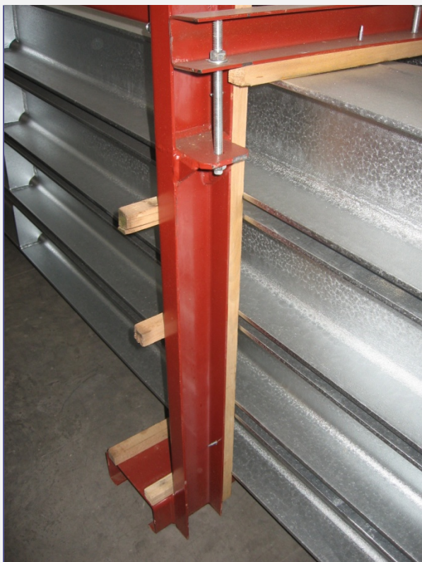
Szakszerű csomagolás légrésekkel, megfelelő távtartókkal, él védelemmel.
