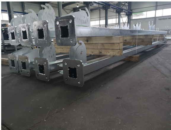
6. kép: A sérülésmentes szállításhoz csomagolás párnafákkal
