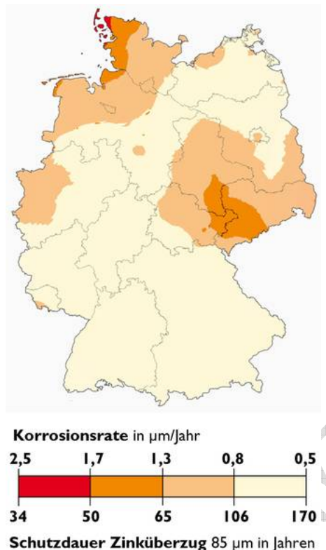
2. kép: A cink korróziós veszteségei Németországban (Forrás: www.feuerverzinken.com )
