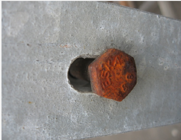
A túl vékony (galvanizált) horganybevonatok idő előtt lepusztulnak.
