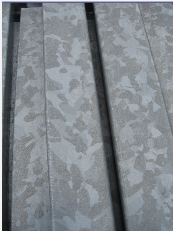
A horganybevonatok kiváló ellenálló képességét a felületükön kialakuló tömör oxid (cinkpatina) adja.
