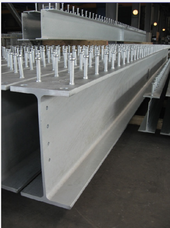
Vastagabb acélangyakon – ugyanazon acélminőségénél - vastagabb horganyrétegek képződnek.
