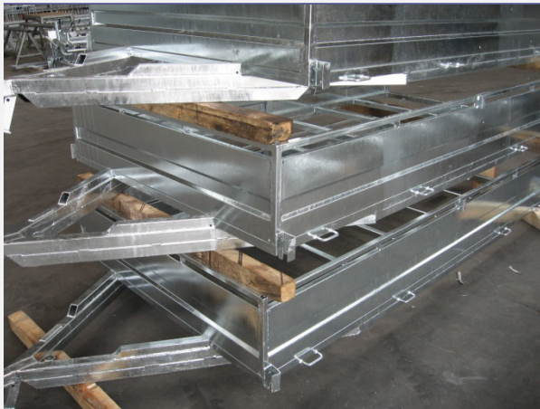
Vékony lemezekből készített acéltermékek horganyfelvétele - azonos acélminőség esetén - nagyobb.
