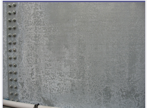
Nagyfelületű, és frissen horganyzott lemezek (táblák) erősen érzékenyek a fehérrozsodásra.
