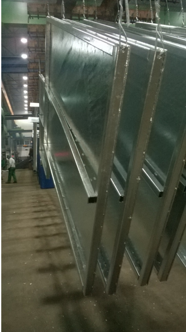
2. kép: Vastag lemezen vékonyfalú szelvény leválása
