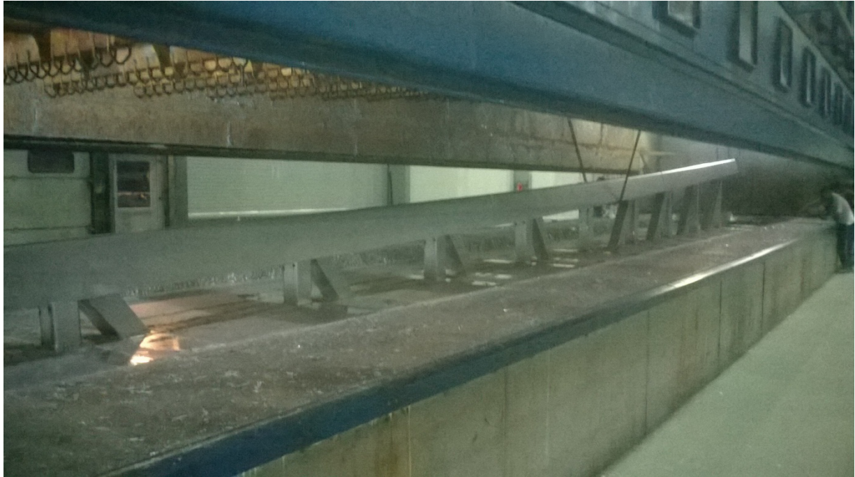
14. kép: Nagyméretű zártszelvény övekkel rendelkező szerkezet horganyzás közben jól láthatóan „ívelődik”
