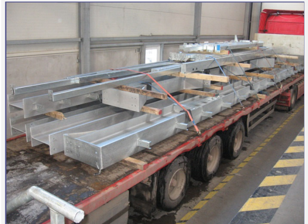
Megfelelő módon felrakott, nagyméretű termékek (párnafák alkalmazása és hevederes kikötés).
