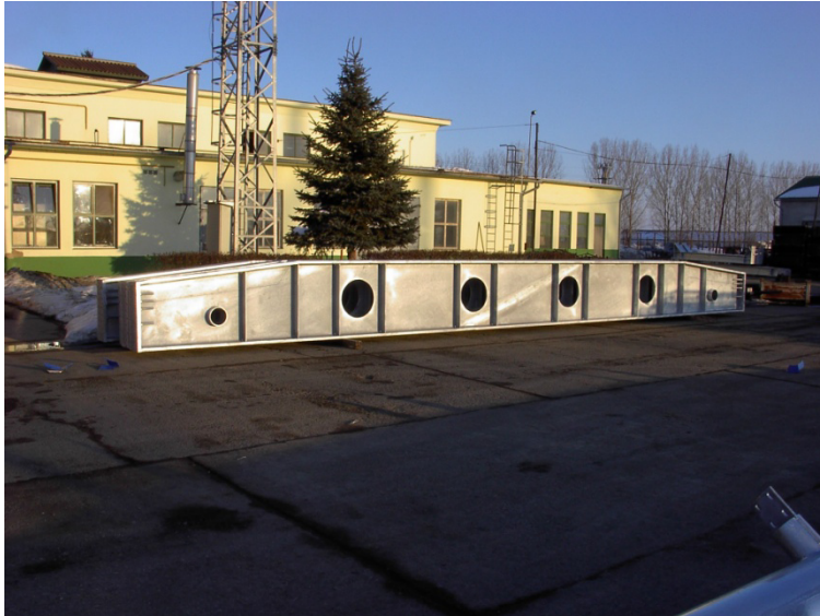
9. kép: Kétszeri mártással horganyzott darab néhány hét után
