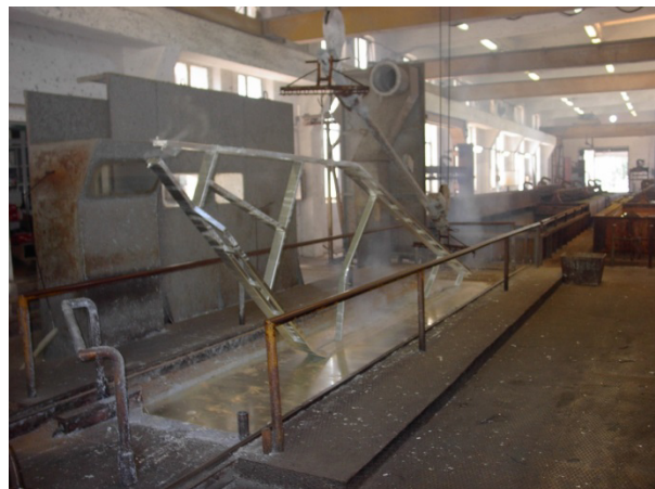
5-6. kép: Egy alváz egyik oldalának horganyzása (balra), majd a másik rész bevonása (jobbra)
