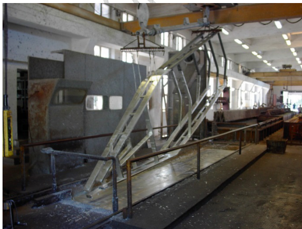
5-6. kép: Egy alváz egyik oldalának horganyzása (balra), majd a másik rész bevonása (jobbra)
