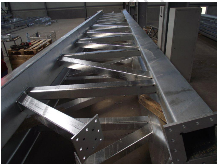
8. kép: Kétszeri mártással horganyzott darab felületei
