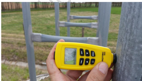
8. kép: Rétegvastagság 10 mikrométer
