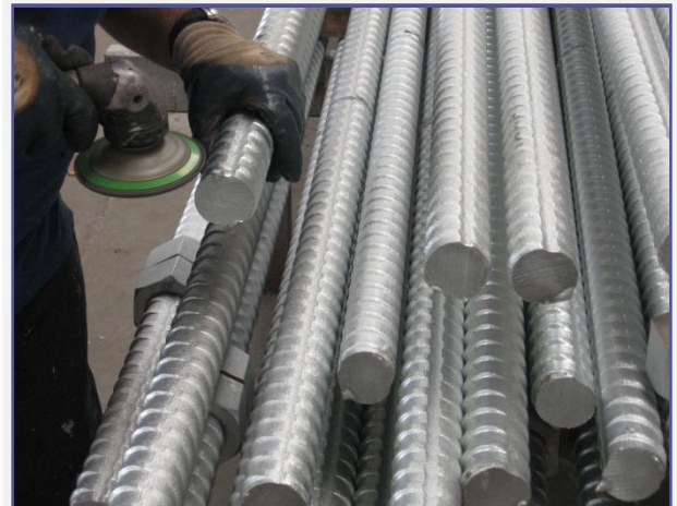
Nagyátmérőjű tűzhorganyzott betonacélok (rúdacélok) bevonást követő tisztítás közben.
