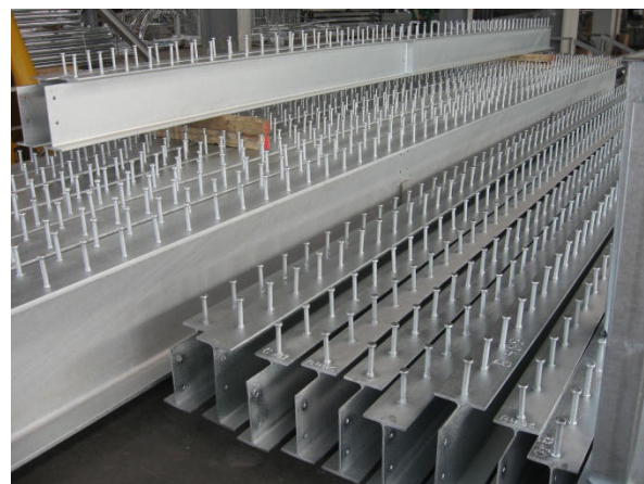
4-5. kép: Tűzihorganyzott betonacélok és betonozáshoz kialakított, horganyzott
