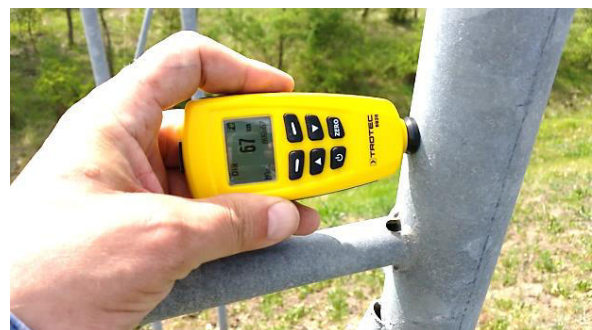
9. kép: Rétegvastagság 67 mikrométer
