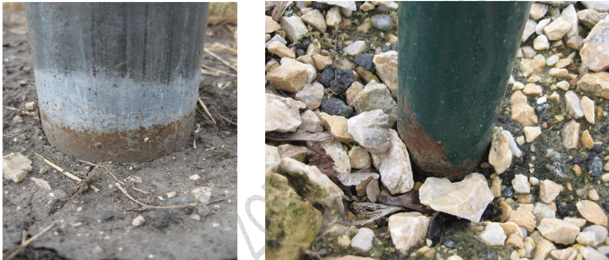
10-11. kép: Vékonybevonatos és porszórással védett cső korróziója talaj közelében
