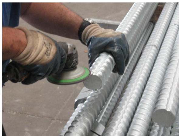
4-5. kép: Tűzihorganyzott betonacélok és betonozáshoz kialakított, horganyzott
