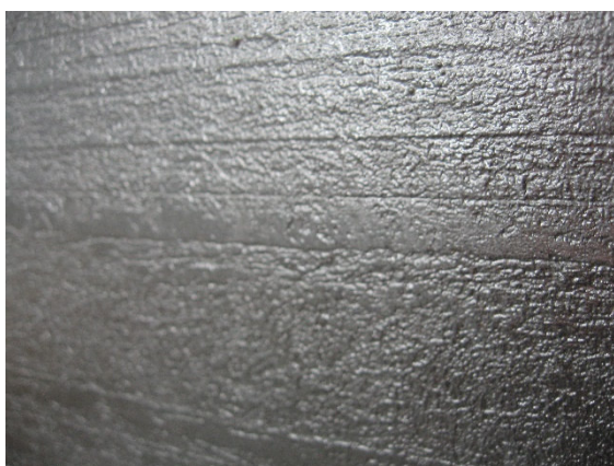
Kedvezőtlen kémiai összetételű (reaktív) acél horganybevonata (további információk → MSZ EN ISO 14713-2 szabványban)
