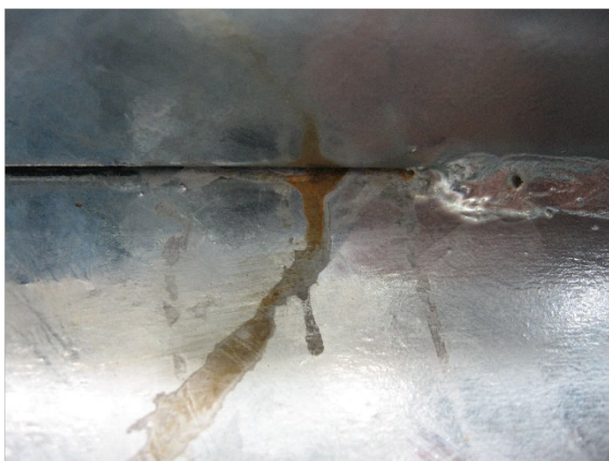
Hegesztési varrat melletti rés szivárgása
