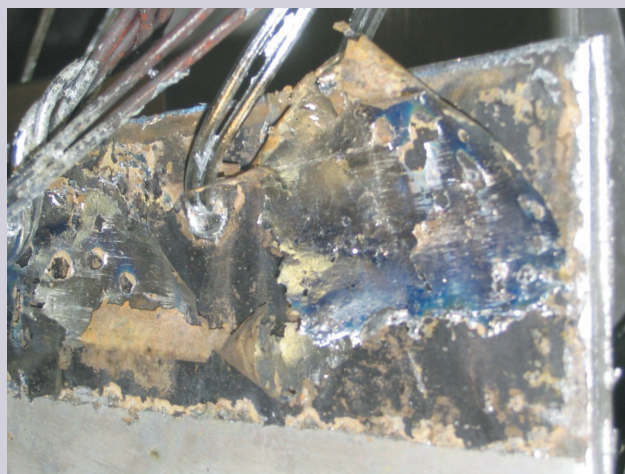
Ragasztós, festékes, bitumenes, stb. felületek bevonathiányt okoznak
