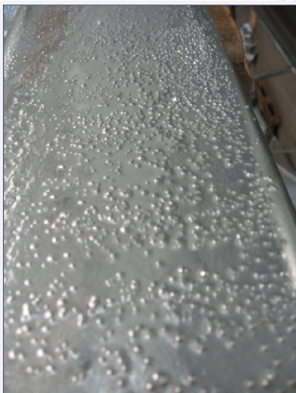
Szemcseszórásból maradt acélsörétek tömege a már tűzhorganyzott felületen
