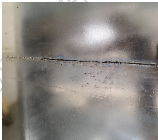
6. kép: Hengerlésből származó anyagrepedés az acél alapanyagban
