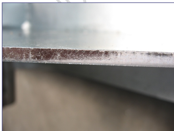
21-22. kép: Balra túl vékony bevonat, jobbra egyenetlen, durva horganyréteg
