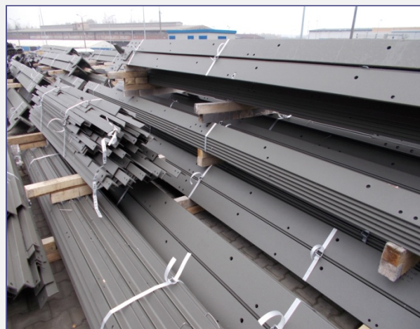
Duplex-védelemmel ellátott, csavarozott kivitelű villamos távvezeték oszlopelemek
