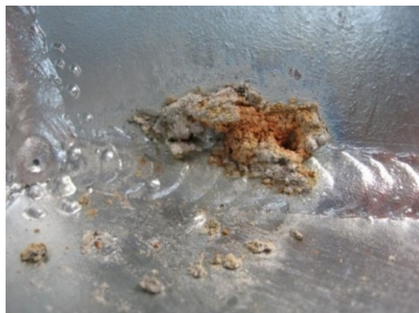
5-6. kép: Horganyzó salak és fluxsó maradványok
