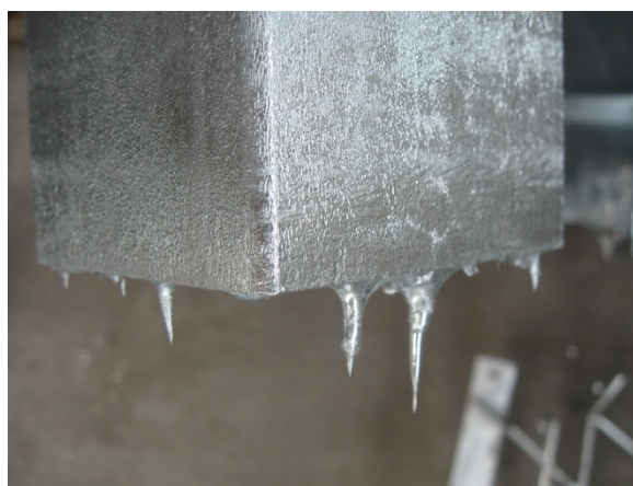
25-26. kép: Megfolyások, cseppek a termék éleken, sarkokon
