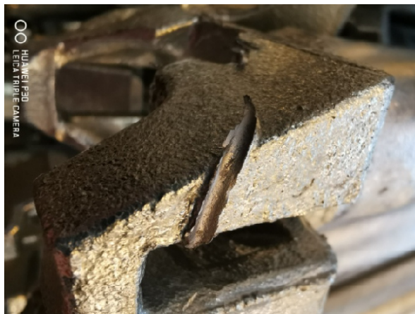
10. kép: Függesztő huzal nyomai a bevonatban
