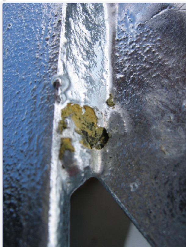
A hegesztési salakok eltávolítása festés előtt fontos, de ezt még gyártás után kellett volna megtenni
