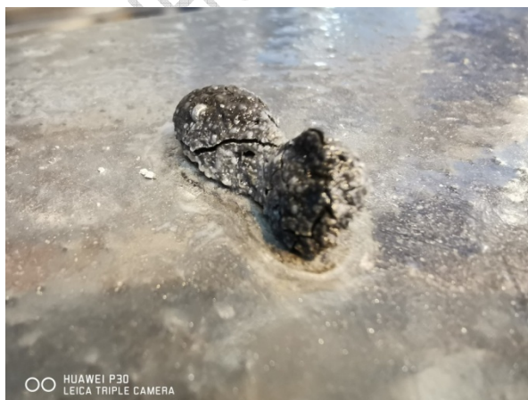
5-6. kép: Horganyzó salak és fluxsó maradványok
