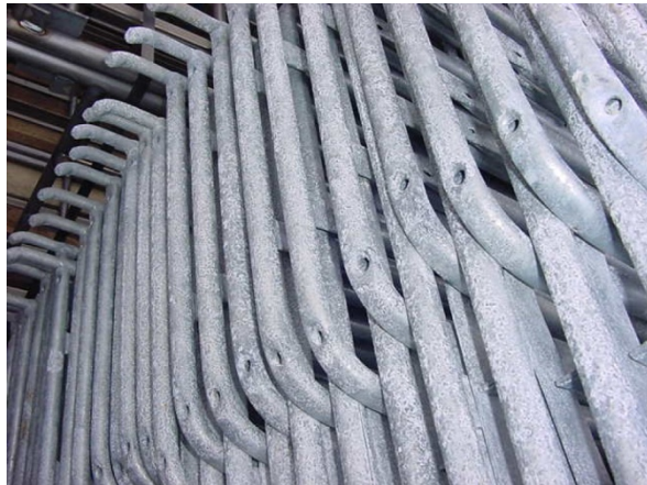
15. kép: Fehérrozdás felületek
