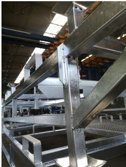
1. kép: Valamennyi sarokpontban technológiai nyílás van
