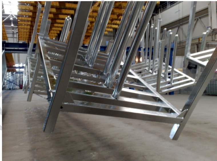
2. kép: Kaloda felkötési és horganyozási helyzete
