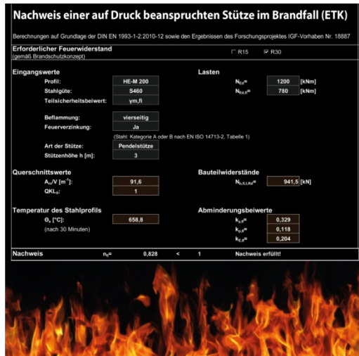
9. kép: A horganyzott acélszerkezet tűzállósága modellel számítható (Forrás:www.feuerverzinken.com)
