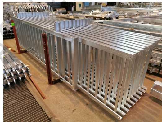
12. kép: Kalodás szállítás óvja a termékek épségét
