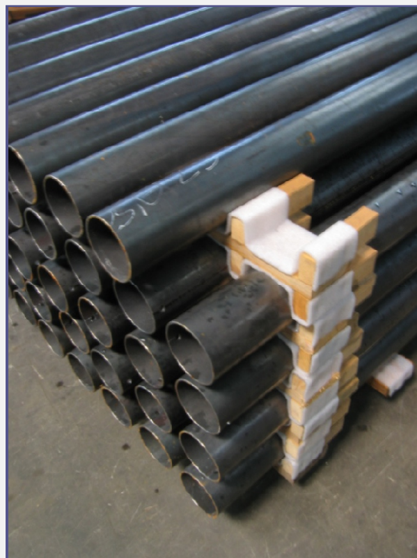
Kifogástalanul csomagolt fekete áru, mely horganyzás után így kerül visszacsomagolásra
