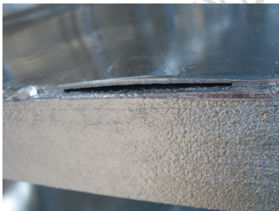
14. kép: A vastag szerkezetre felhegesztett vékony lemez maradandó alakváltozása
