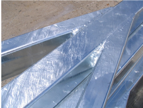
16. kép: Ni-Bi-Al ötvözésű fürdő friss bevonata
