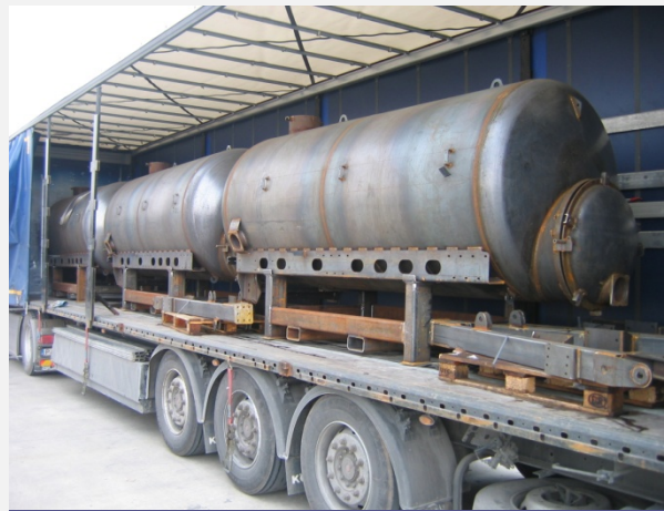
Daruzható és villás targoncával jól kezelhető, helyes rakodás horganyzóba szállításkor
