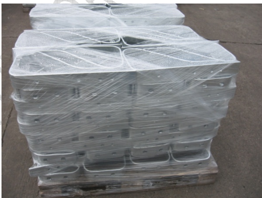
9. kép: A fóliás csomagolás egyszerű, de kockázatos
