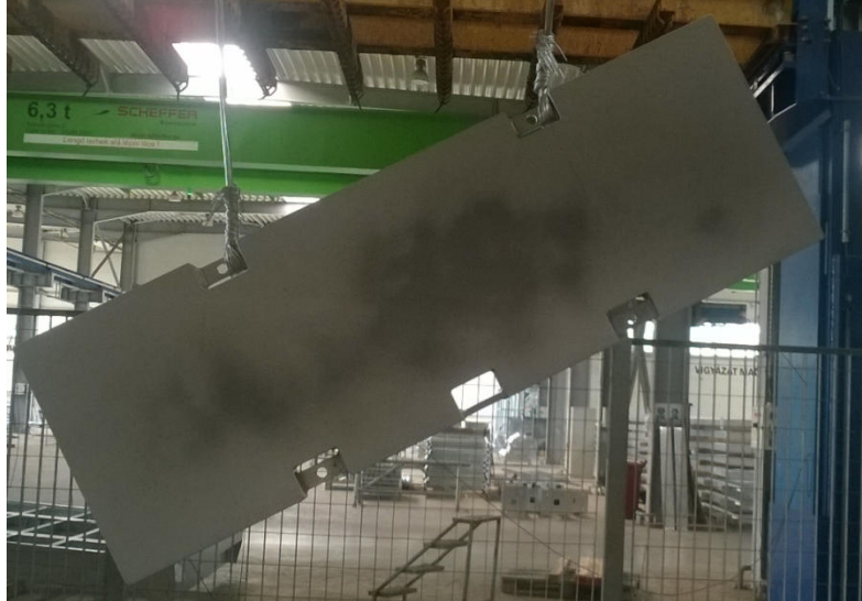
2. kép: Hőfoltok okozta elszíneződés
