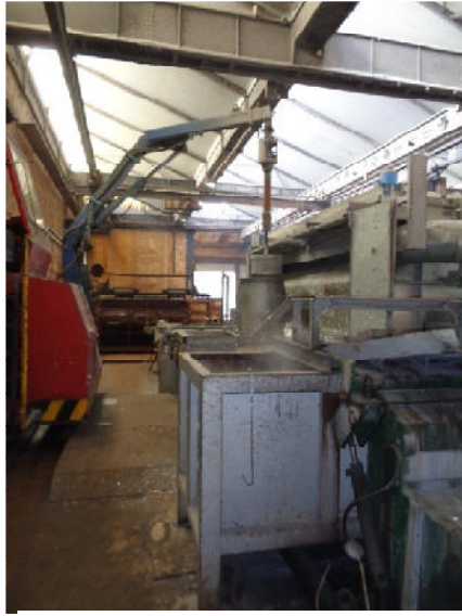
13. kép: A horganyzó daru felemeli az acélkosarat
