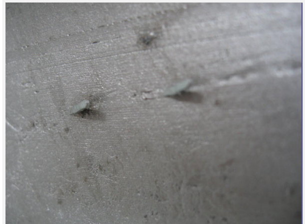
A lemezengерlési hibák tűzihorganyzás után is megmaradnak és jól látszanak.
