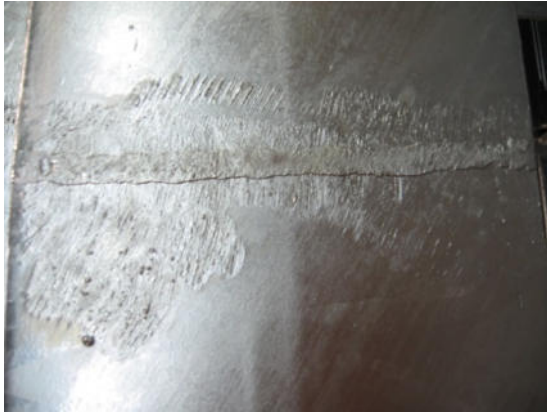
11. kép: Köszörülés nyomai a horganyzott felületeken
