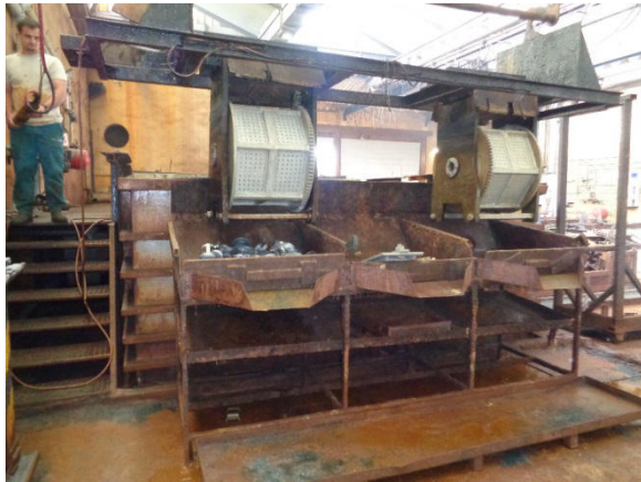
12. kép: A felületelőkészítés műanyag dobokban, ömlesztve történik
