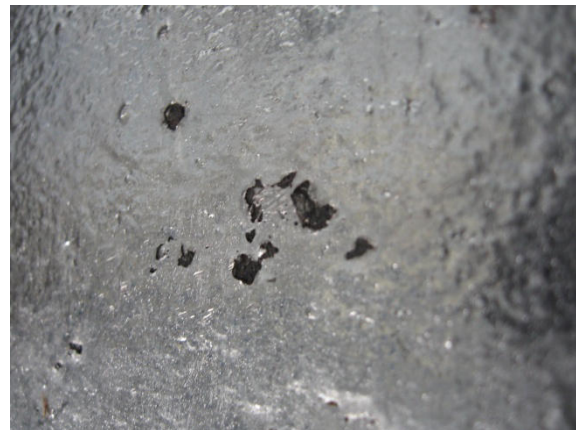
6. kép: Felületbe hengerelt reves a bevonást követően fekete foltokként jelenik meg
