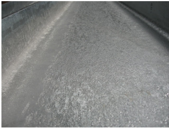
7. kép: Anyagminőség probléma látható a horganyzás után
