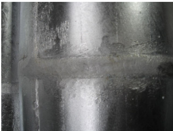
6. kép: Szürke és vastag bevonat a varraton ( v > 150 \mu\text{m} )
