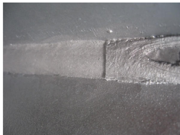
9. kép: Hegesztésről levált túl vastag horganyréteg ( v > 1000 \mu\text{m} )
