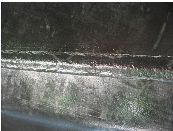
8. kép: Hegvarrat optimális horganyréteggel ( v < 100 \mu\text{m} )
