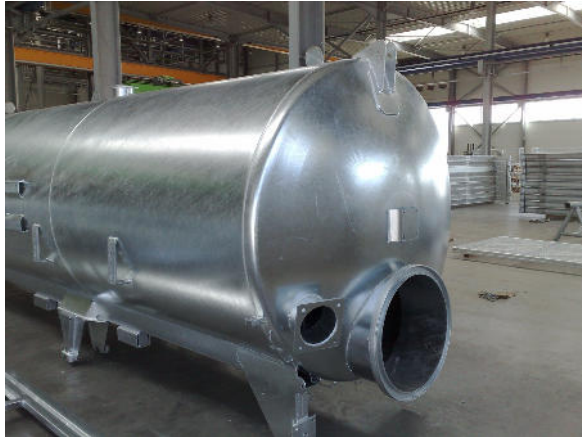
10. kép: Fekvő tartály tűzihorganyozva
