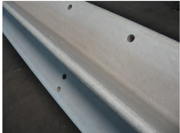
8.- 9. kép: Balra fényes, optimális vastagságú bevonat, jobbra, vastag, szürke horganyréteg
