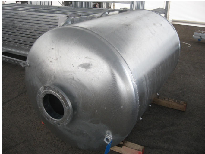
1. kép: Nagyobb tartály jól ellenőrizhető technológiai nyílásokkal
