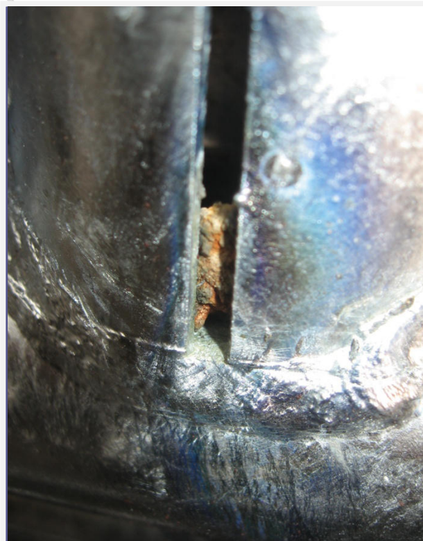
Túl kicsi technológiai nyílás miatt salak maradt a zártszelvényben.
