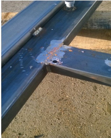
3. ábra: Kisméretű nyílás, helytelenül elhelyezve
