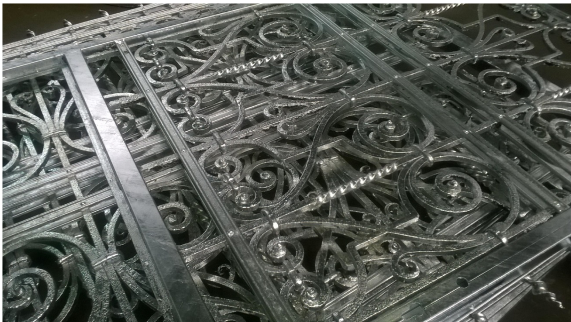
2. ábra: Felújított kerítés horganyozva
