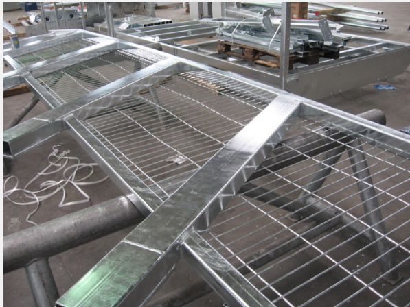
Erősen hullámosodott hálók egy kapun a nem megfelelő konstrukció miatt.
