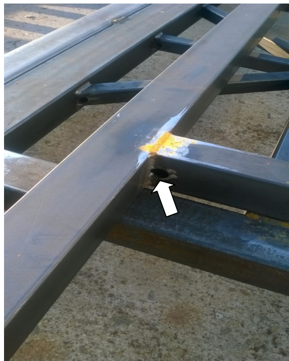
6. ábra: Megfelelő technológiai nyílás, jó pozícióban elhelyezve
