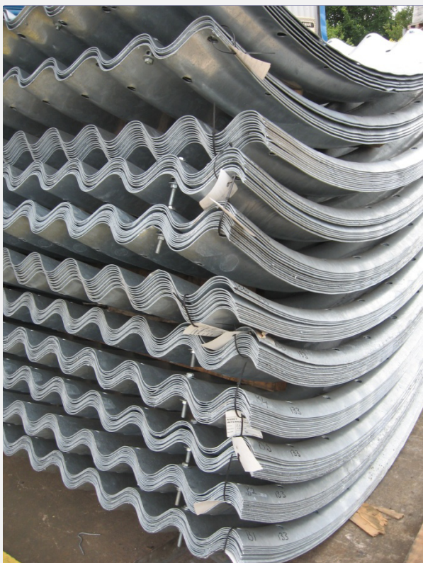
Helytelen tárolás fehérrozsdásodást okozhat. A víz nem tud kifolyni és kiszáradni az egyes darabok közül.
