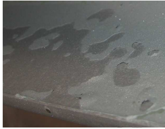
6. ábra: Nem megfelelő szemcseszórási technika miatt szétvált
