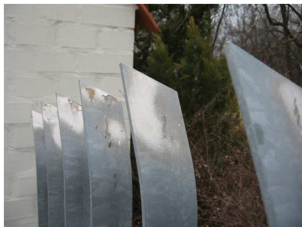
11. ábra: Helytelenül javított horganyzott felület
