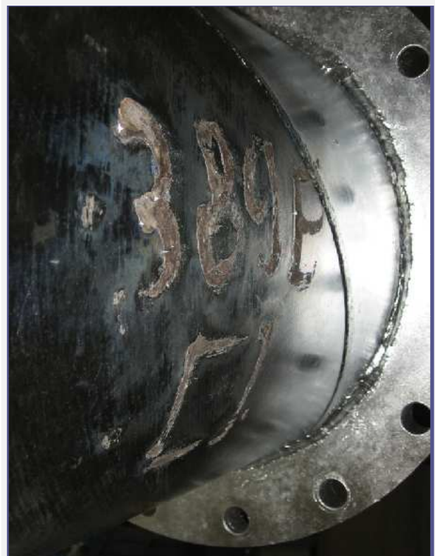
Helytelen jelölés ráfestett számokkal. Horganyzást követően bevonathiányos felületek javításra szorulnak.
