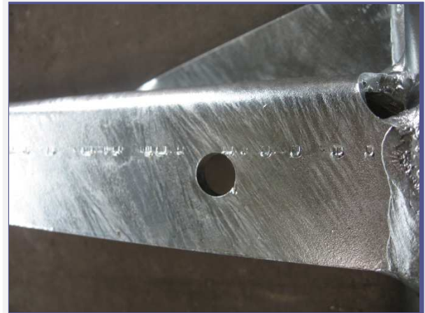
Az alakító szerszámok nyomai tűzihorganyzást követően meglátszanak.
