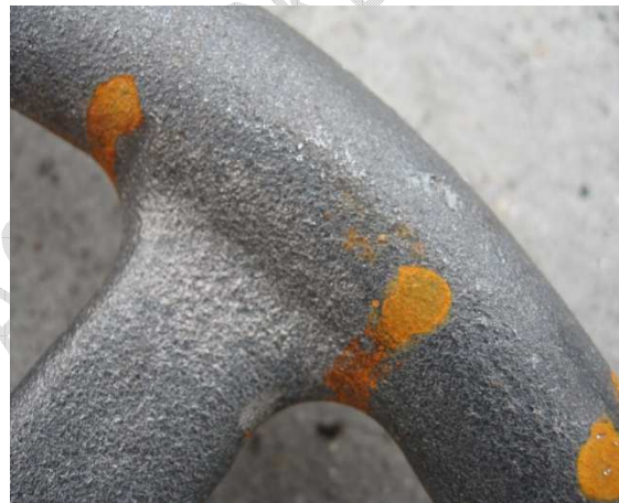
2. ábra: Homokszórt öntvényfelület még horganyzás előtt
