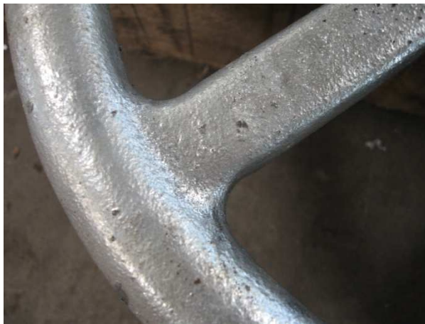
1. ábra: Apróbb horganyhiányok és szennyeződések az öntvény felületén
