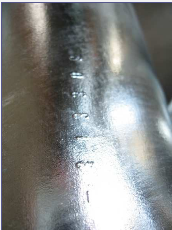
A jelölést helyes és célszerű is megfelelő helyre beütött számokkal elvégezni.
