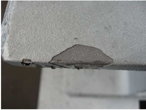
5. ábra: Mechanikai behatás miatt szétvált horganybevonat
