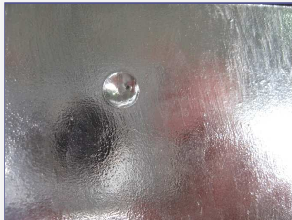
Amennyiben túl kicsi furatokat választunk ( \varnothing < 6 mm), főleg vékony anyagoknál a lyuk eltömődik horgannyal.
