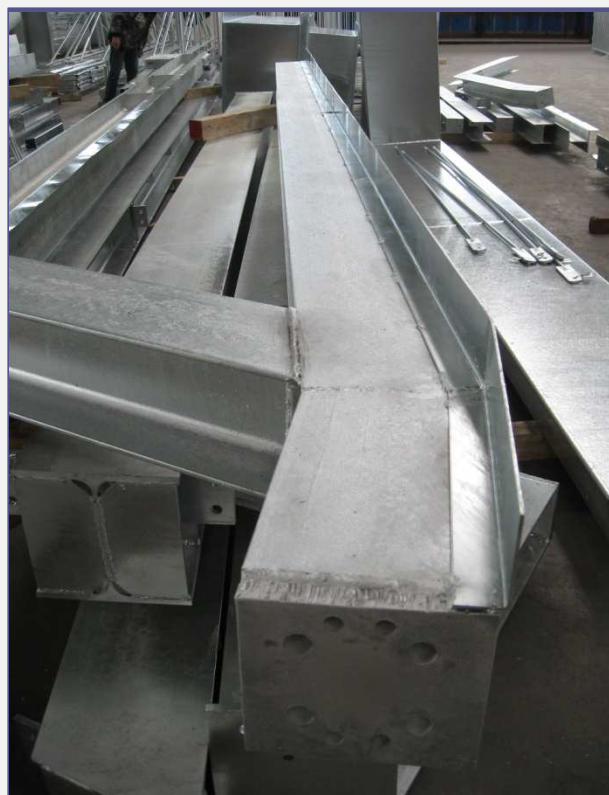
Túl nagy vastagságkülönbségű részeket hegesztettek össze, mely a vékony elem meg hullámosodott.
