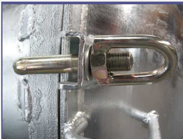
A galvanikusan horganyzott kapcsolóelem beépítése – tartós kültéri igénybevételnél nem ajánlott megoldás.
