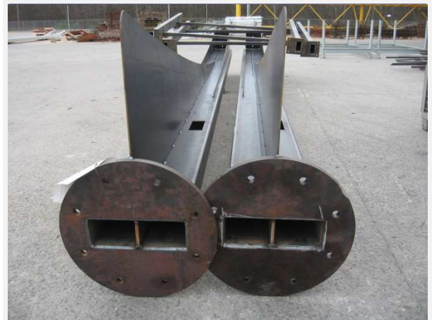
A zártszelvények teljes kinyitása gyors bemeletést és olcsóbb, szebb horganybevonatokat tesz lehetővé.
