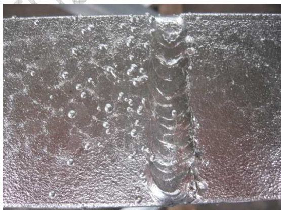
5. ábra: Freccsenések nyomai
