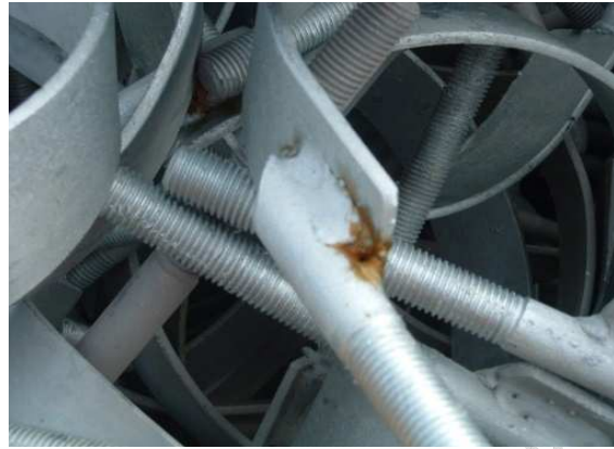
4. ábra: Le nem zárt hegesztés egy korróziós góc
