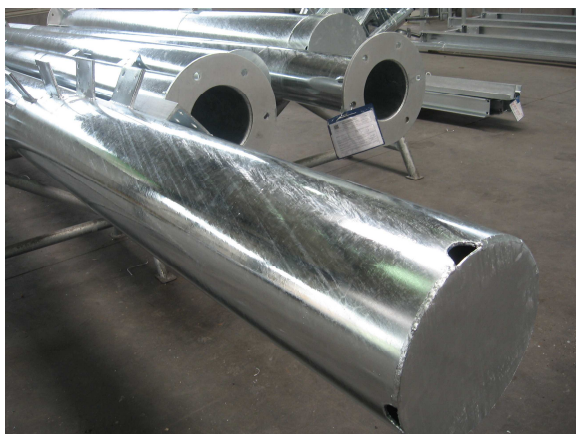
18. ábra: Helyes kilevegőző nyílások (optimális megoldás)
