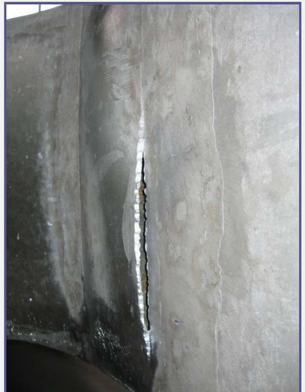
A gőz által szétrobbantott felület, a termék sérülésével is járt. Az utólagos javítás többletköltségekkel jár.
