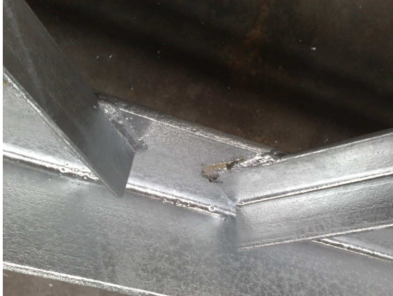
12. ábra: Kisméretű átlapolás horganyzási hibával, a nem kellően tömör varrat miatt
