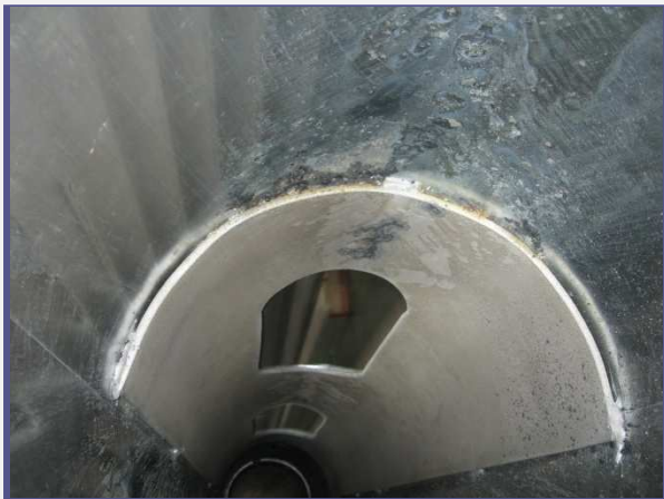
Az rálapolás alatt az acélfelületet nem lehet lepácolni, emiatt salakfelpadások keletkezhetnek.
