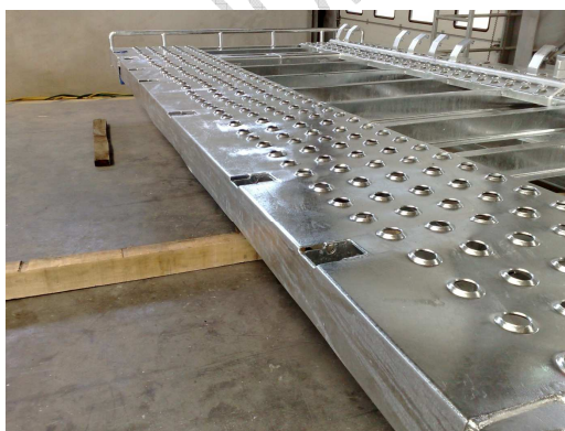
5. ábra: Lemezszerkezet minimális deformációval
