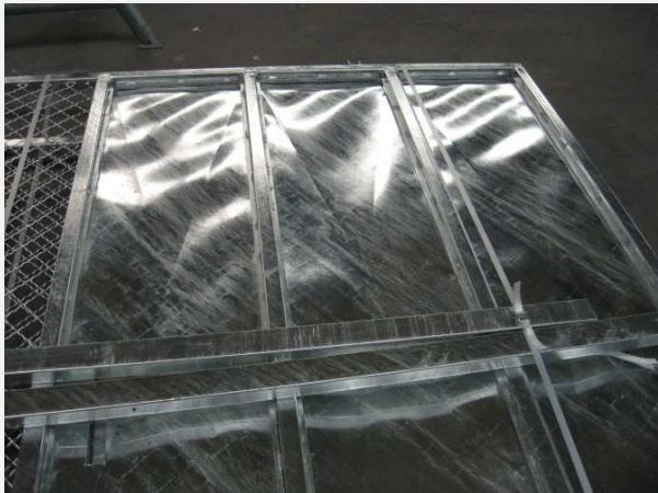
Nem elegendő mértékű merevítés esetén, szintén káros alakváltozással kell számolni.
