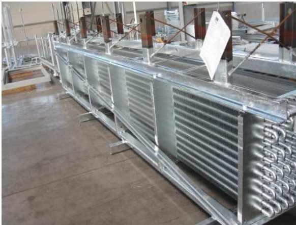
9. ábra: Hosszú hőcserélő a merev befoglaló keretben
