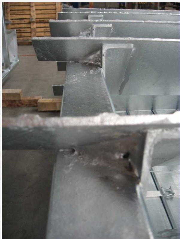
Hiányzó technológiai nyílások miatt horganymaradványok a sarkokban
