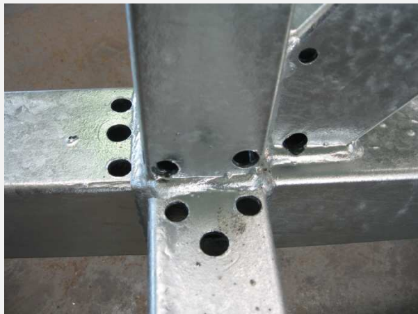
Utólag fűrt, nem optimális , részben felesleges technológiai nyílások zártszelvényen
