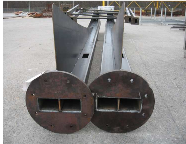
12. ábra: Optimális technológiai nyílások
